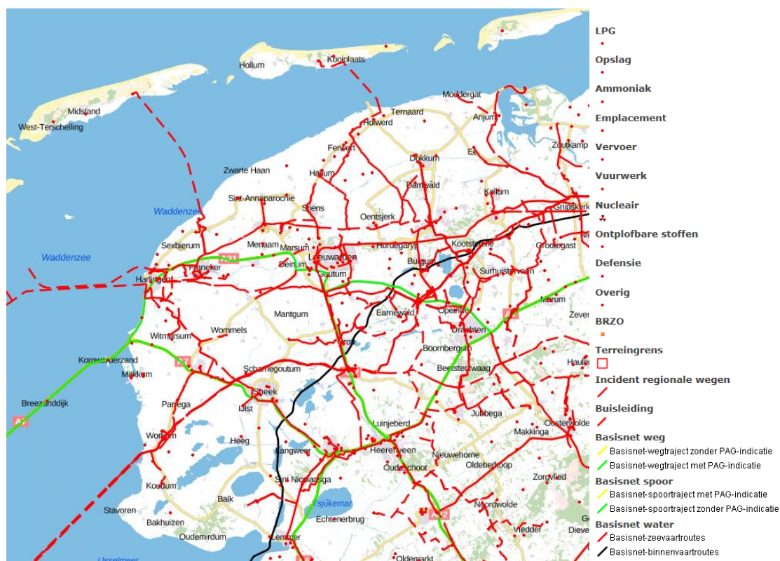
Figuur 5.10 Risicokaart externe veiligheid met ligging inrichtingen en transportroutes gevaarlijke stoffen [www.risicokaart.nl]
