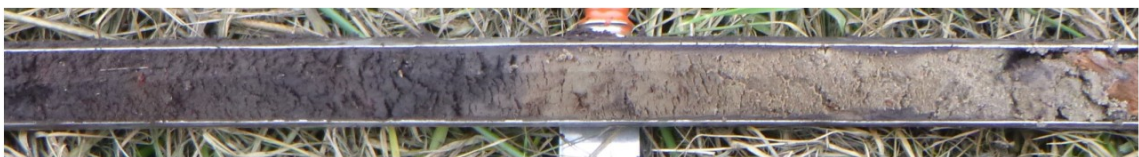
Figuur 3: Koningsdiep: De klei (beekleem; bij het mes) zoals deze plaatselijk in het plangebied is aangetroffen. Links hiervan is veen te zien en rechts de doorwortelde top van het dekzand.
