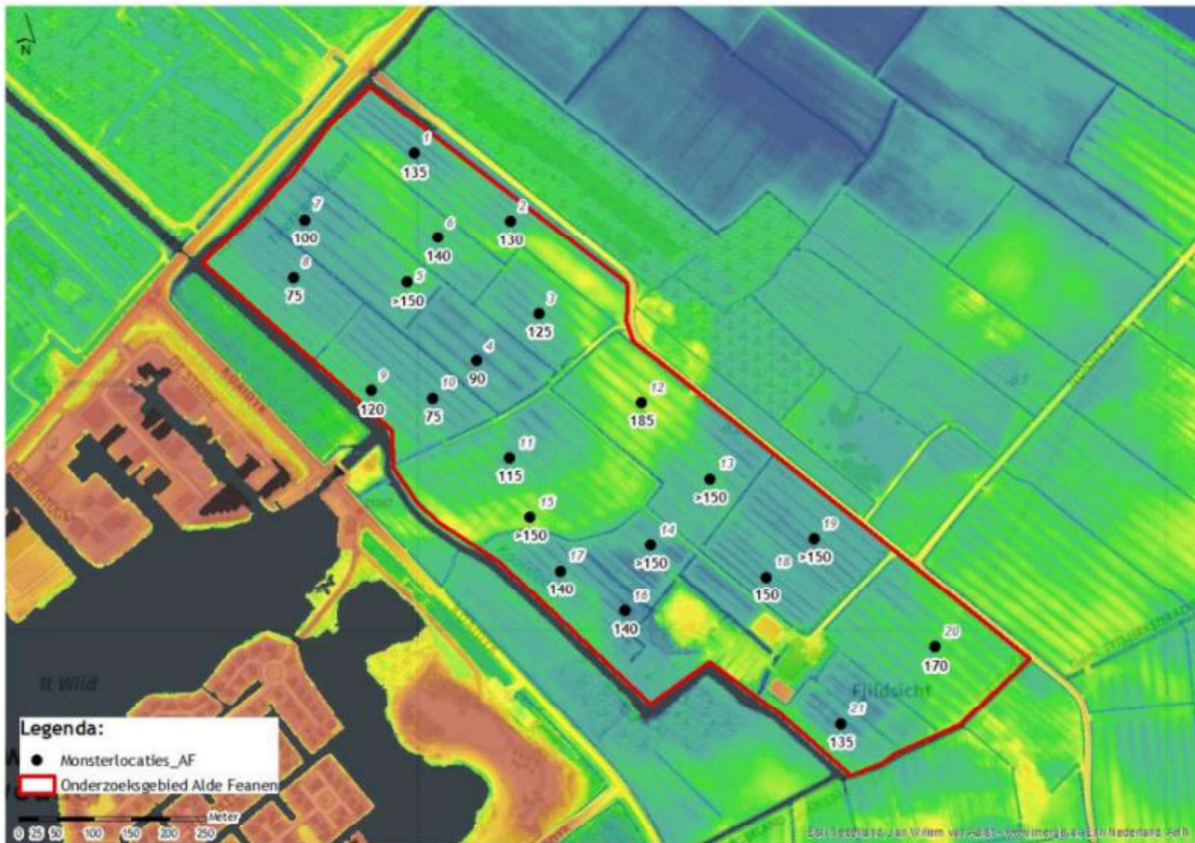
Figuur 0-5 Overzicht van de boring met nummer en diepte keileem t.o.v. maaiveld in polder Siderius, geprojecteerd op een hoogekaart [3]
