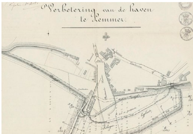
Plattegrond van de havens van Lemmer met daarop de in 1888 aangelegde buitenhaven en de nieuwe zeesluis. Ter hoogte van het huidige Burgemeester Krijgerplein is de in 1881 omgelegde Lemster Rien aangegeven, met daarin een keersluis.
