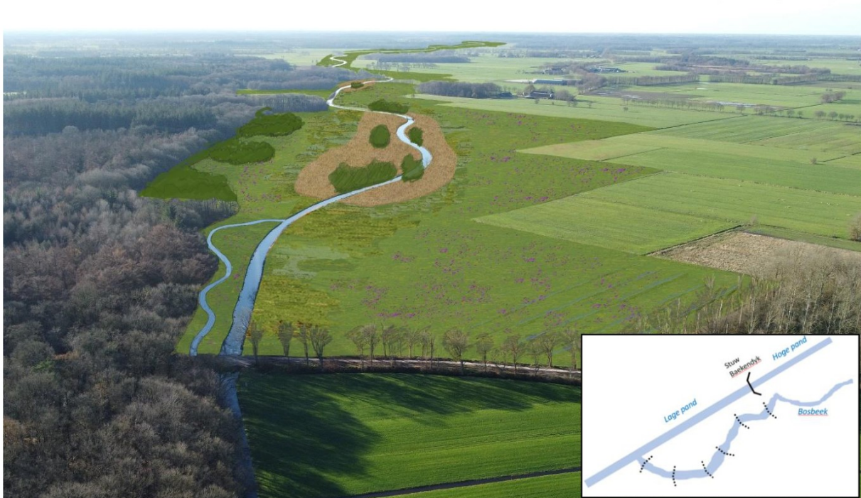
Figuur 4. Indicatieve 3D-impressie van de situatie bij de Beakendyk met de vispassage. De zigzaggende lijnen geven indicatief de visstrappen weer. De details van de vispassage worden nader uitgewerkt in het bestek.
