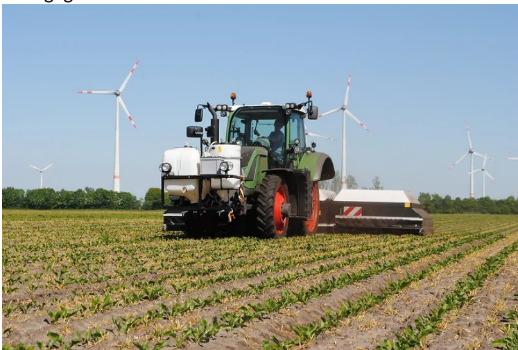
Figuur 2: Ter illustratie een spotsprayer in suikerbieten.
