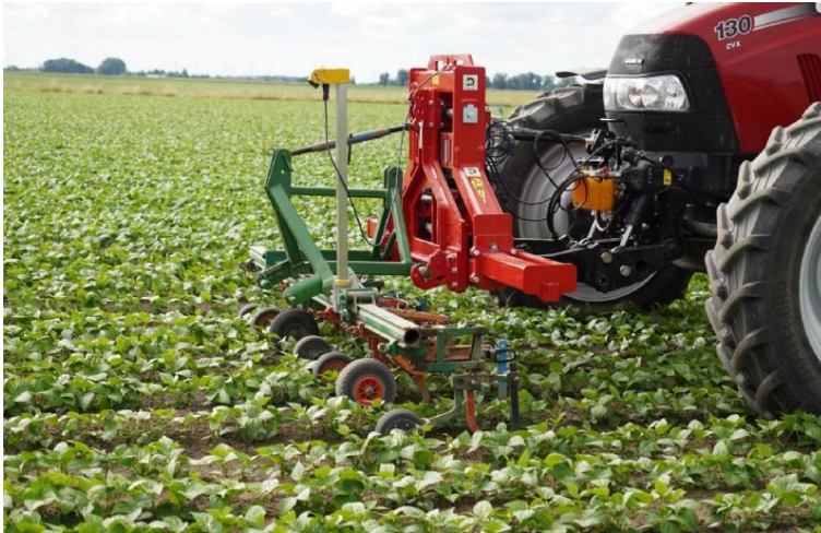
Figuur 3: Ter illustratie een camera gestuurde schoffel in sperziebonen.
