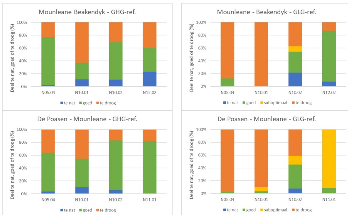
Figuur 3-17 Toets van de ambities voor natuur aan de GHG en GLG in de referentiesituatie. Per natuurdoeltype is aangegeven in hoeverre wordt voldaan aan de gewenste grondwaterstanden.
