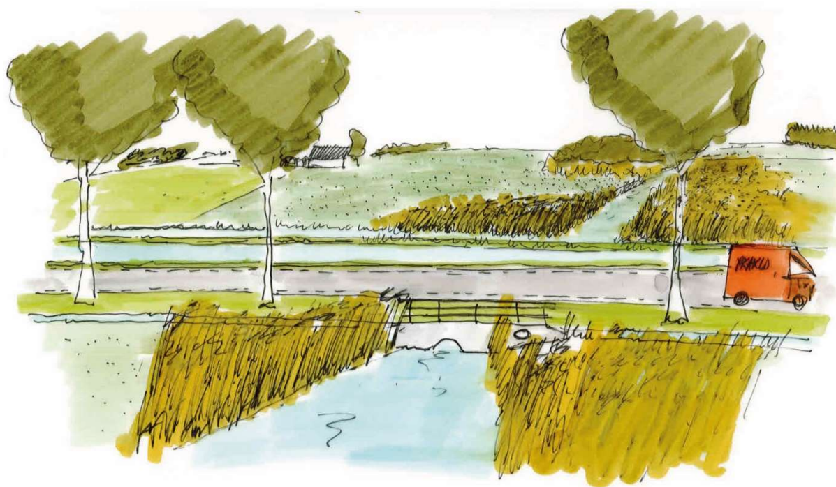
Figuur 7: Beekonderleider en faunapassage onder de Bakkefeanster Feart
