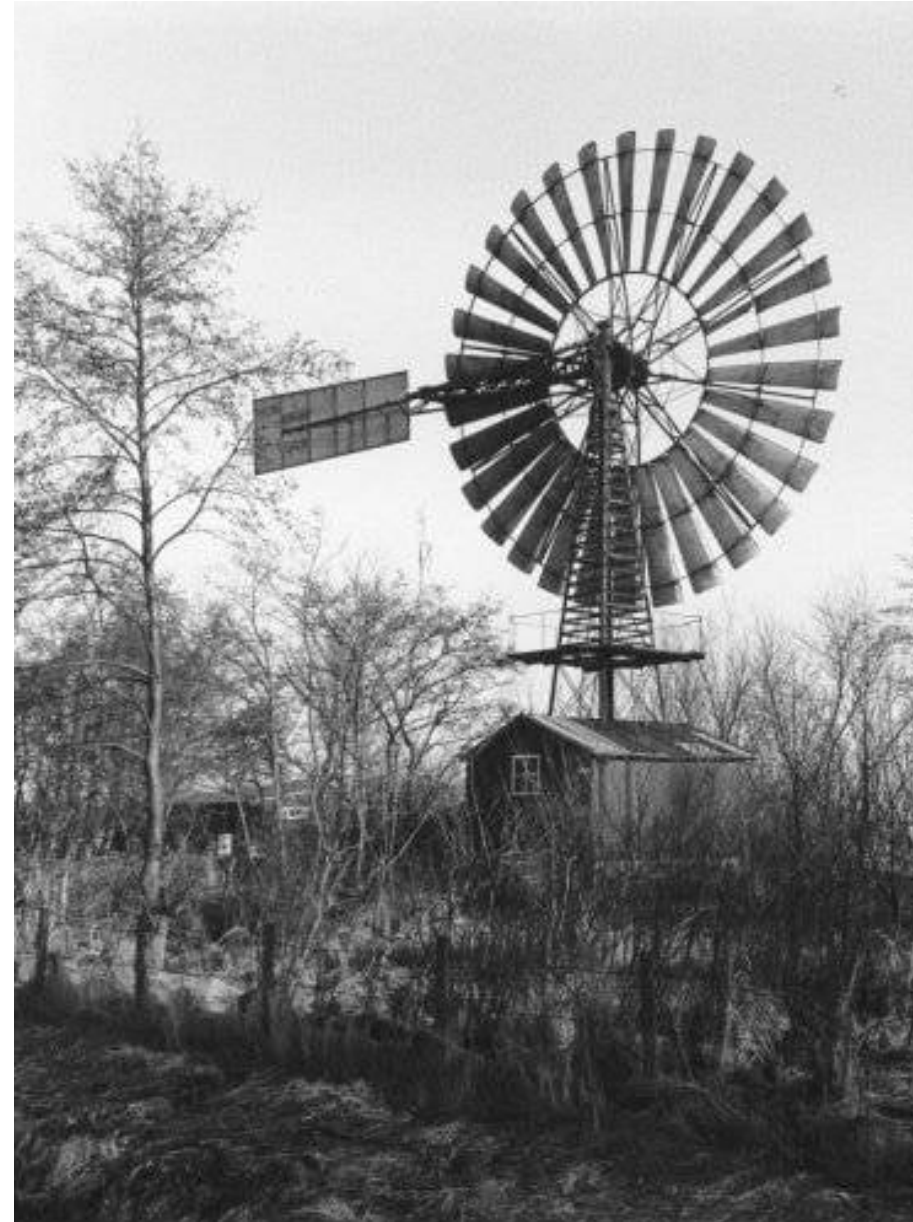
Figuur 33. Een Amerikaanse windmolen. Deze molen heeft jarenlang het overvloedige polderwater uit de waterschapspolder De Hege Warren gepompt.
