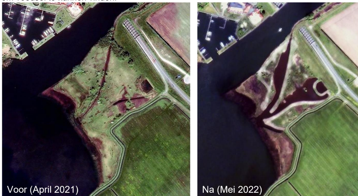
Figuur 4: Slenken in de Galamadammen-West zijn verder uitgediept en breder gemaakt.
