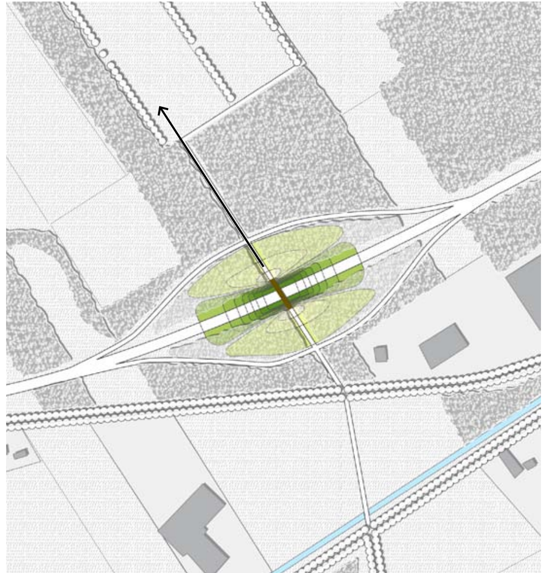
planvoorstel halfverdiepte aansluiting Oudemirdum.
