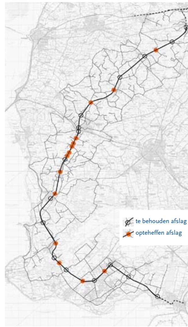
bij de omvorming van de N359 tot stroomweg wordt het aantal ongelijkvloerse afslagen terug gebracht van 37 naar 15.
