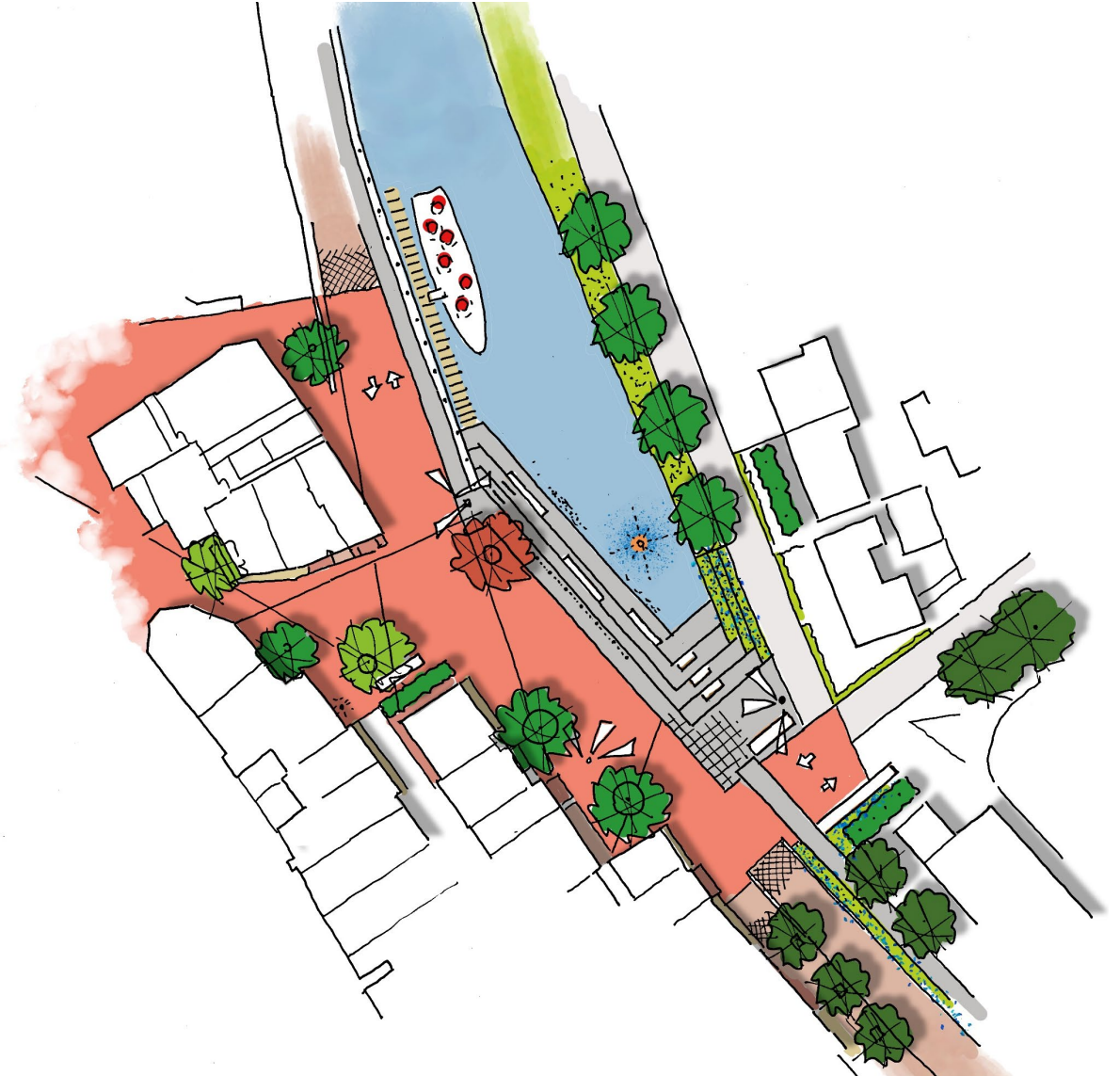
Variant 2: trappen rondom de havenkom damwand verwijderen en treden naar het water toevoegen
