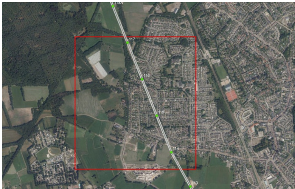
Figuur 3.1 | Zoekgebied kabeltracé tussen mast 114 en mast 117 in de 150 kV lijnverbinding tussen Heeze en Maarheeze.
