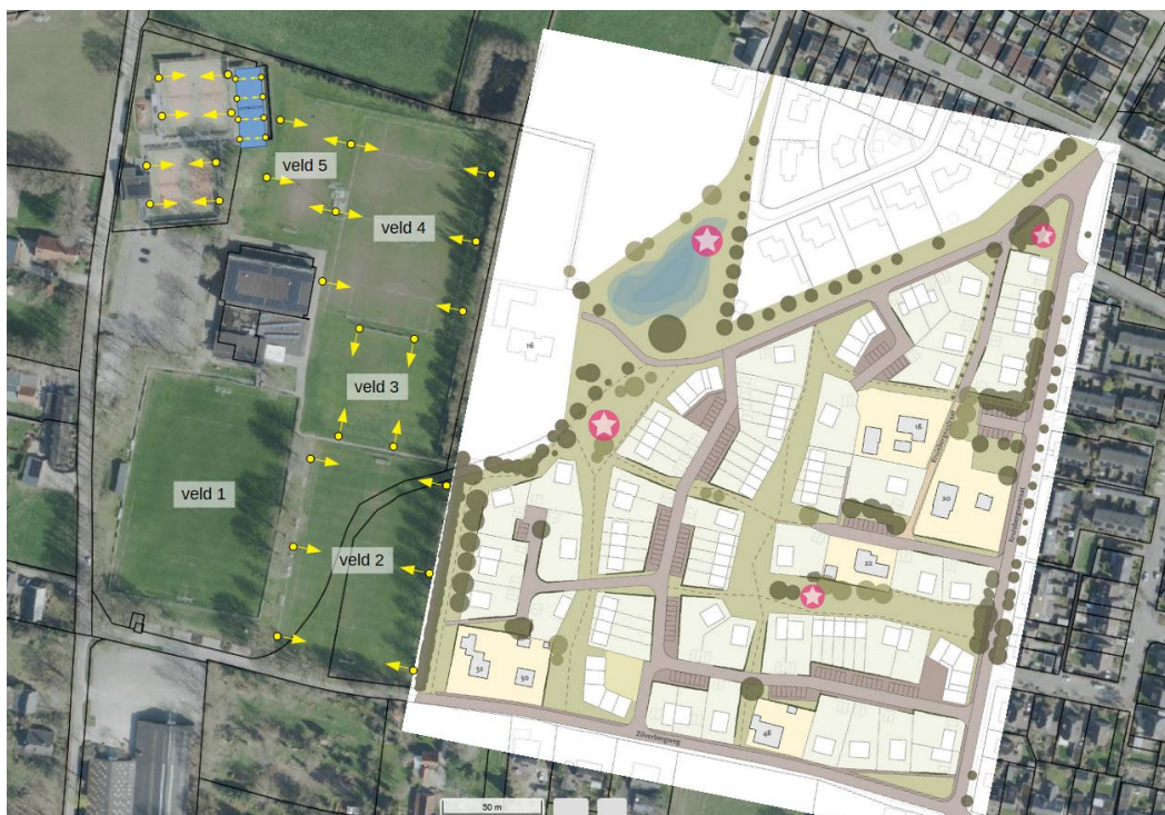
f 2.1 Sportvelden De Passelegt met situering lichtmasten en globale uitstralingsrichting armaturen (geel)
