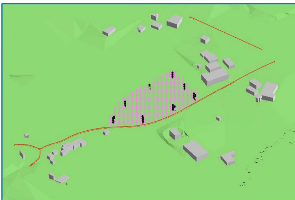
Afbeelding 3. Rekenmodel wegverkeerslawai, 3d-weergave
