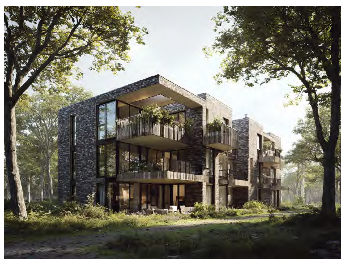
Alzijdig gebouw (plastisch) met een combinatie van inpandige en uitkragende balkons
