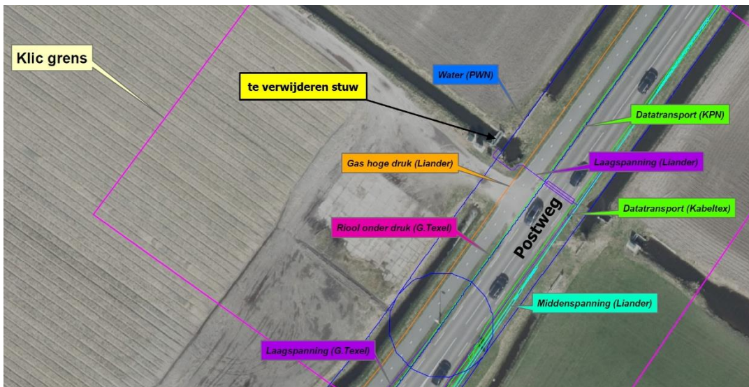
Figuur 5:Overzicht van de kabels en leidingen op de locatie van de te verwijderen stuw Texaco
