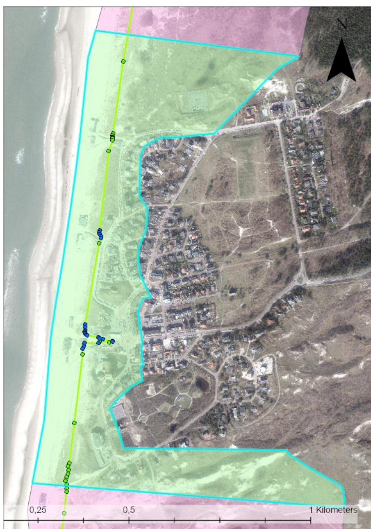
Figuur 23: Bergen aan Zee omringd door lichtblauwe lijn. De punten geven de maatgevende meest landwaarts natte punten van de afslagberekeningen uit XBeach weer bij de signaleringsparameter (1/3000, huidige situatie). De kleur geeft de trend in de tijd weer (groen: zeewaarts, blauw stabiel, rood: landwaarts)
