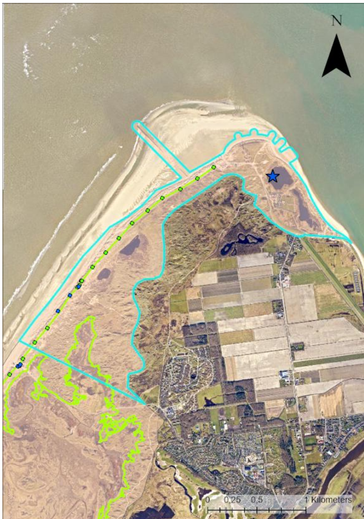
Figuur 8: Eierlandse duinen omringd door lichtblauwe lijn. De punten geven de maatgevende meest landwaarts natte punten van de afslagberekeningen uit XBeach weer bij de signaleringsparameter (1/3000, huidige situatie). De kleur geeft de trend in de tijd weer (groen: zeewaarts, blauw stabiel, rood: landwaarts).
