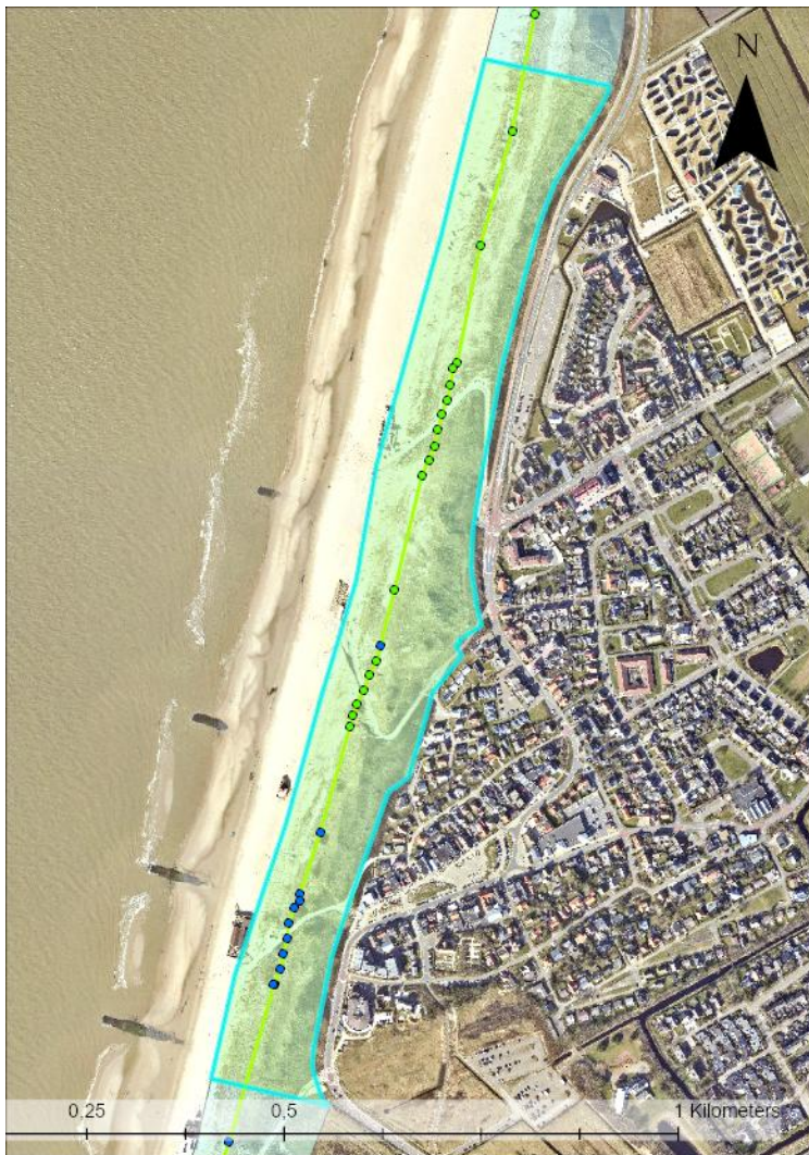
Figuur 19: Callantsoog omringd door lichtblauwe lijn. De punten geven de maatgevende meest landwaarts natte punten van de afslagberekeningen uit XBeach weer bij de signaleringsparameter (1/3000, huidige situatie). De kleur geeft de trend in de tijd weer (groen: zeewaarts, blauw stabiel, rood: landwaarts)
