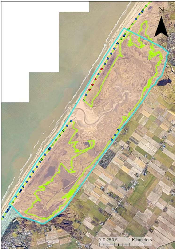
Figuur 9: De Slufter omringd door lichtblauwe lijn. De punten geven de maatgevende meest landwaarts natte punten van de afslagberekeningen uit XBeach weer bij de signaleringsparameter (1/3000, huidige situatie). De kleur geeft de trend in de tijd weer (groen: zeewaarts, blauw stabiel, rood: landwaarts).
