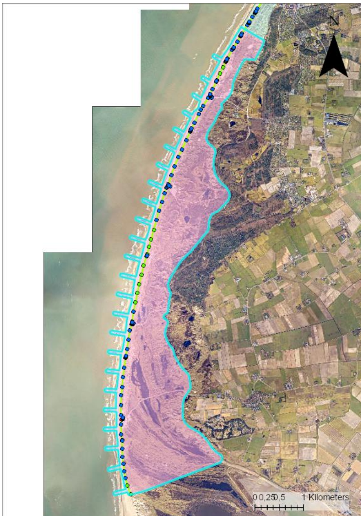
Figuur 11: Westerduinen omringd door lichtblauwe lijn. De punten geven de maatgevende meest landwaarts natte punten van de afslagberekeningen uit XBeach weer bij de signaleringsparameter (1/3000, huidige situatie). De kleur geeft de trend in de tijd weer (groen: zeewaarts, blauw stabiel, rood: landwaarts)
