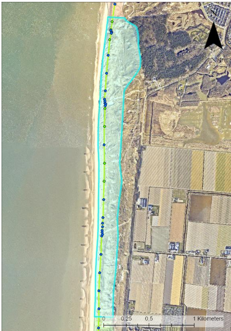
Figuur 16: De Noordduinen omringd door lichtblauwe lijn. De punten geven de maatgevende meest landwaarts natte punten van de afslagberekeningen uit XBeach weer bij de signaleringsparameter (1/3000, huidige situatie). De kleur geeft de trend in de tijd weer (groen: zeewaarts, blauw stabiel, rood: landwaarts)
