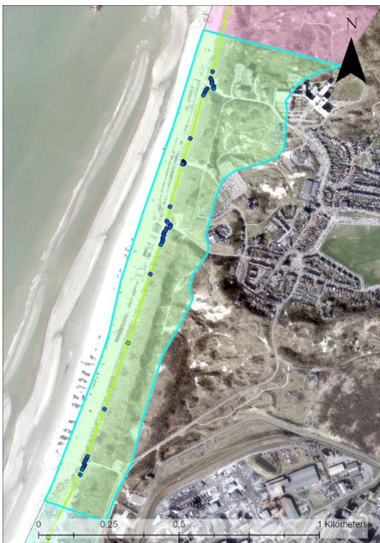
Figuur 27: Wijk aan Zee omringd door lichtblauwe lijn. De punten geven de maatgevende meest landwaarts natte punten van de afslagberekeningen uit XBeach weer bij de signaleringsparameter (1/3000, huidige situatie). De kleur geeft de trend in de tijd weer (groen: zeewaarts, blauw stabiel, rood: landwaarts)
