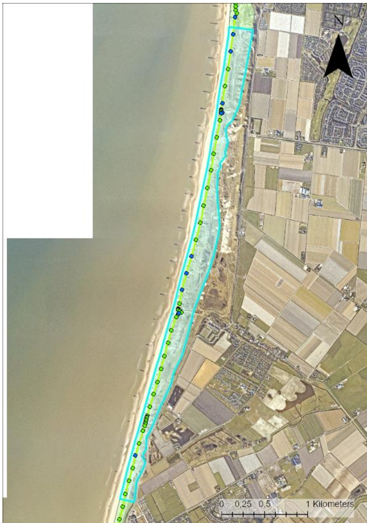
Figuur 18: Groote Keeten omringd door lichtblauwe lijn. De punten geven de maatgevende meest landwaarts natte punten van de afslagberekeningen uit XBeach weer bij de signaleringsparameter (1/3000, huidige situatie). De kleur geeft de trend in de tijd weer (groen: zeewaarts, blauw stabiel, rood: landwaarts)
