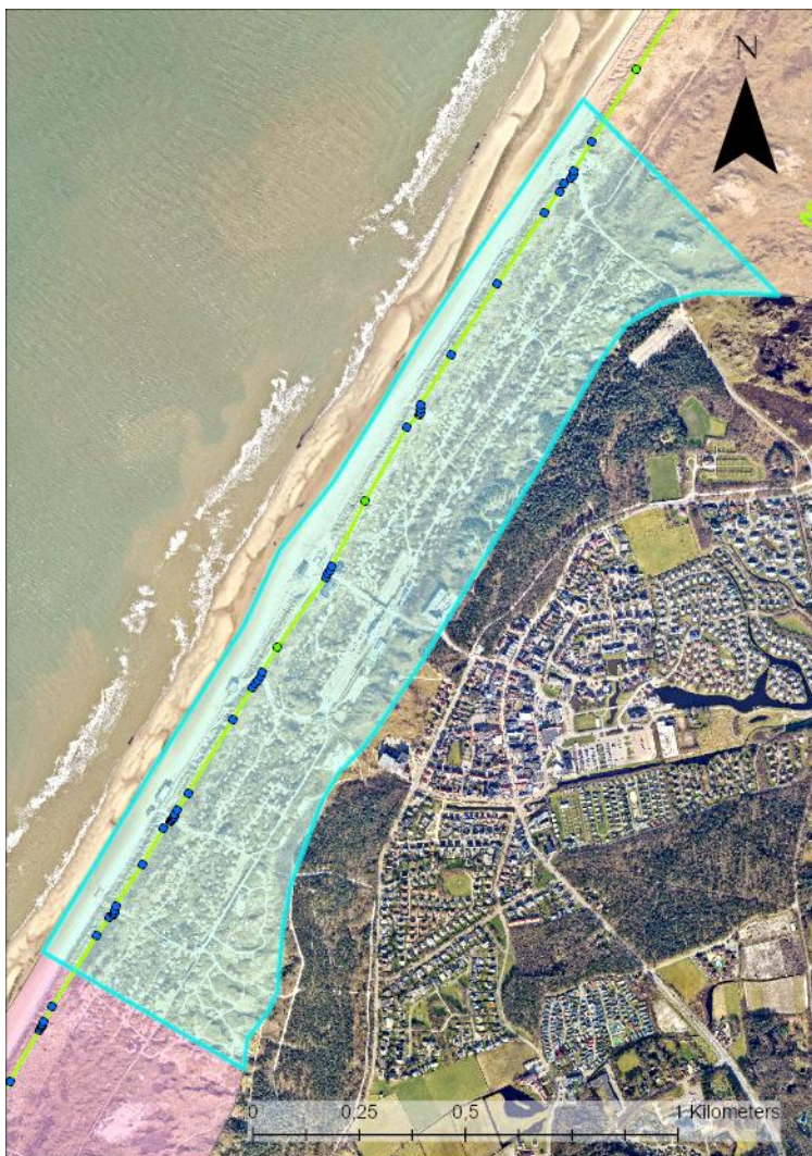
Figuur 10: De Koog omringd door lichtblauwe lijn. De punten geven de maatgevende meest landwaarts natte punten van de afslagberekeningen uit XBeach weer bij de signaleringsparameter (1/3000, huidige situatie). De kleur geeft de trend in de tijd weer (groen: zeewaarts, blauw stabiel, rood: landwaarts).
