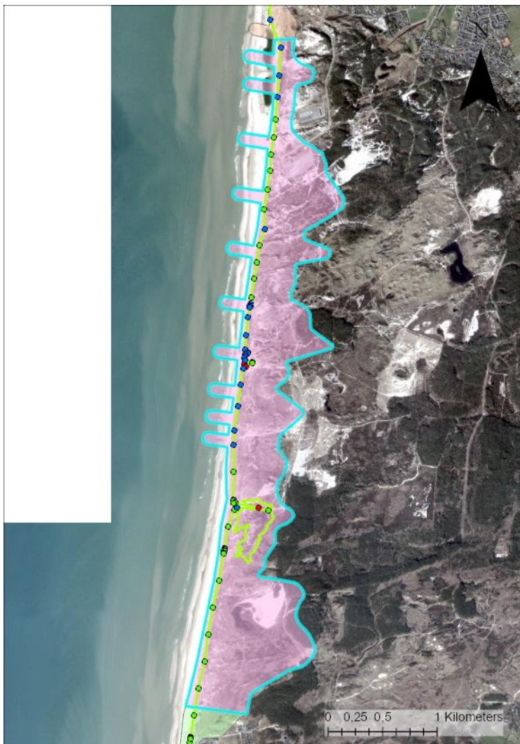
Figuur 22: Schoorlse Duinen omringd door lichtblauwe lijn. De punten geven de maatgevende meest landwaarts natte punten van de afslagberekeningen uit XBeach weer bij de signaleringsparameter (1/3000, huidige situatie). De kleur geeft de trend in de tijd weer (groen: zeewaarts, blauw stabiel, rood: landwaarts)
