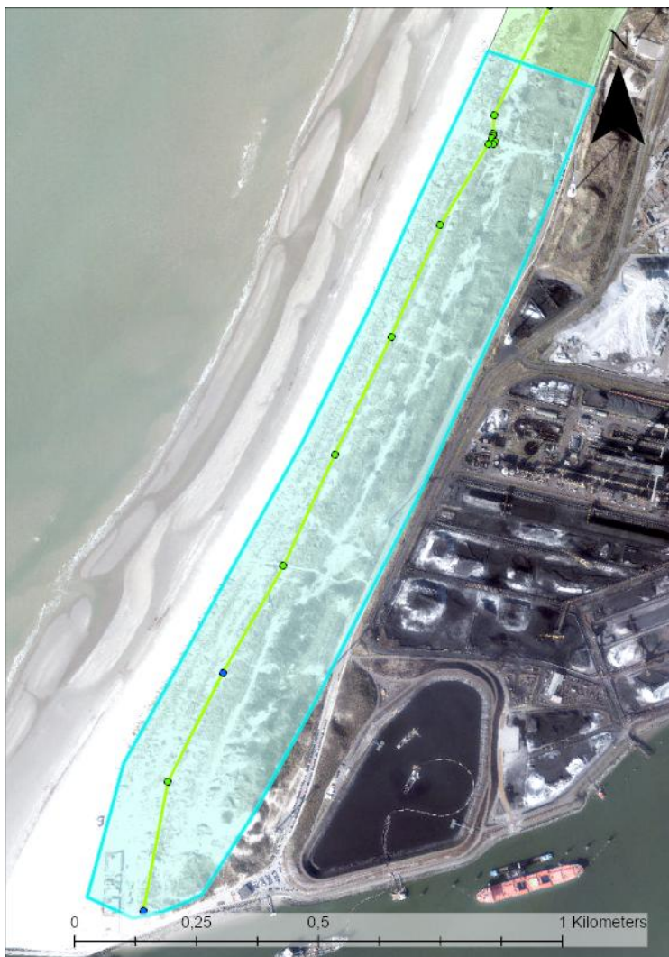
Figuur 28: Stalen Duinen omringd door lichtblauwe lijn. De punten geven de maatgevende meest landwaarts natte punten van de afslagberekeningen uit XBeach weer bij de signaleringsparameter (1/3000, huidige situatie). De kleur geeft de trend in de tijd weer (groen: zeewaarts, blauw stabiel, rood: landwaarts)
