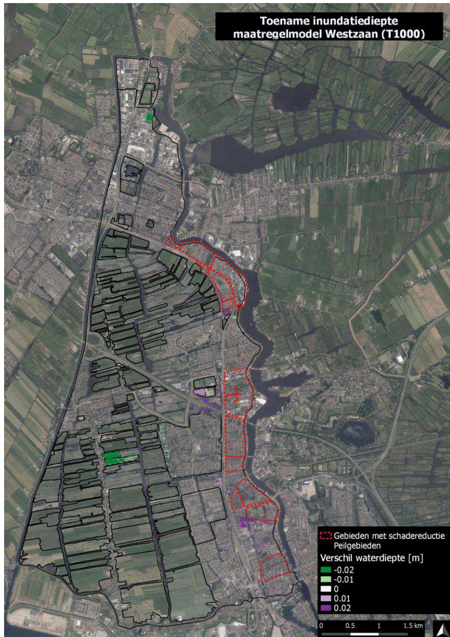
Figuur 40. Verschilkaart inundatiediepte referentie model en maatregel model.
