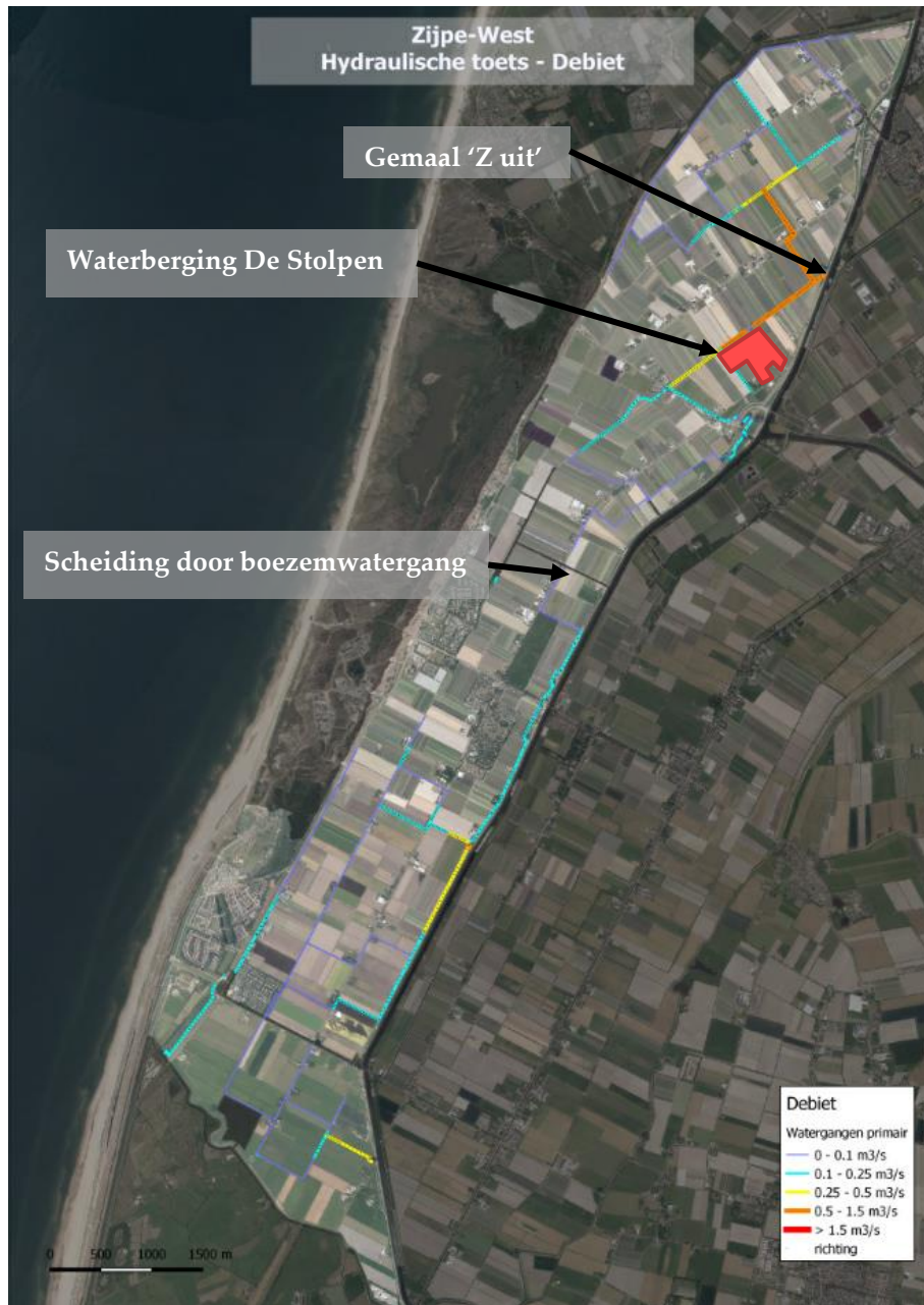
Figuur 43. Debiet in de Zijpe-West op basis van de hydraulische toetsing.
