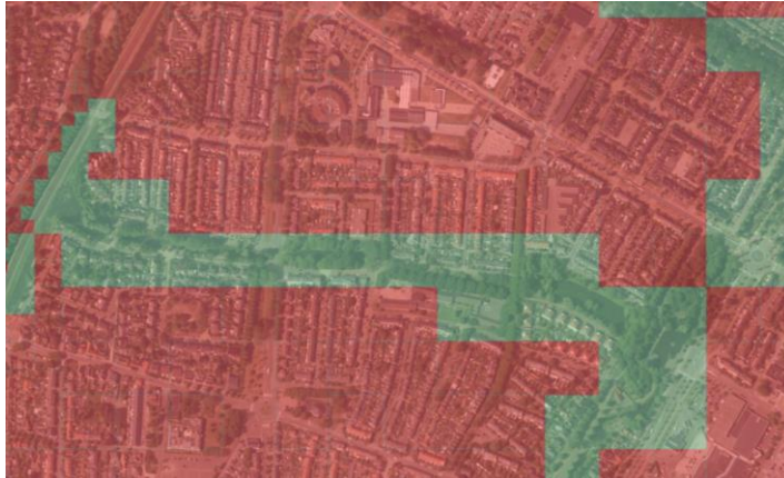
Figuur 67. Detailuitsnede van de filterkaart. In het groen de cellen die representatief zijn voor inundatie vanuit het watersysteem (gelegen aan een watergang) en in het rood de cellen die representatief zijn voor inundatie als gevolg van plasvorming op het maaiveld.
