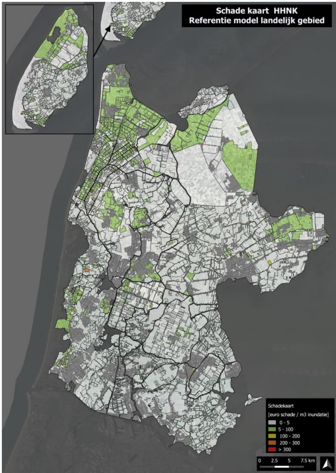
Figuur 99. Schade per kuub inundatie voor het landelijk gebied behorende bij een T100 blokbui.
