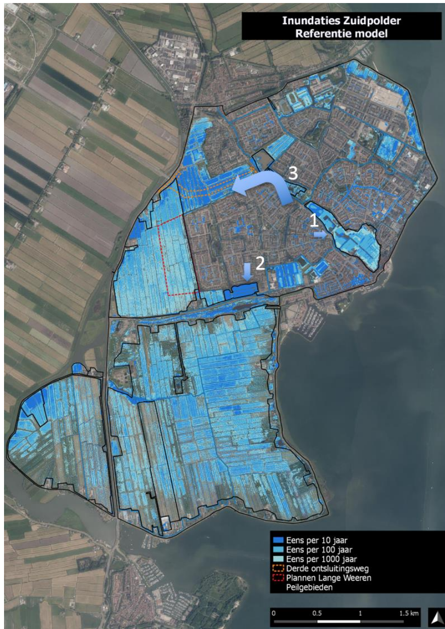
Figuur 33. Inundaties bij extreme situaties. De pijlen geven de richting van de stroming weer.
