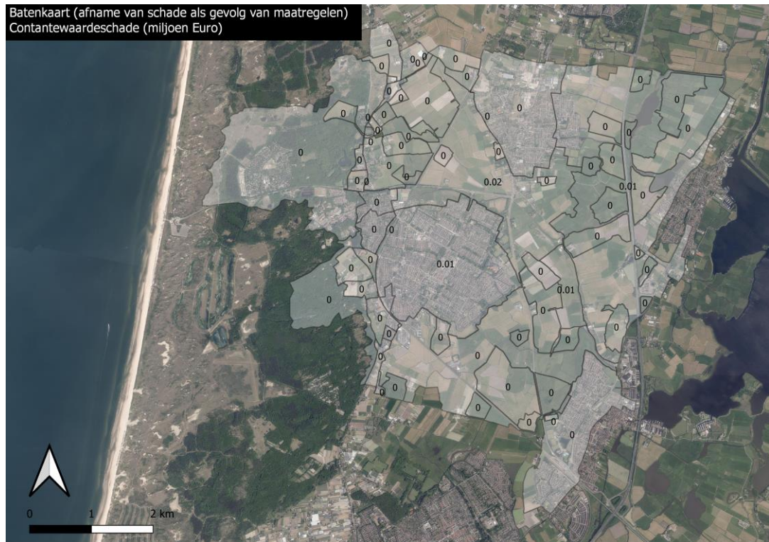
Figuur 84. Batenkaart als gevolg van afname van inundaties uit het watersysteem.
