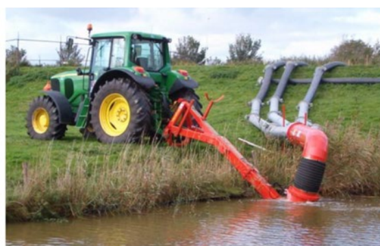
Figuur 29 Pomp met een tractor die tijdens calamiteiten snel kan worden ingezet.
