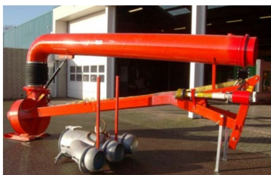
Figuur 29 Pomp met een tractor die tijdens calamiteiten snel kan worden ingezet.
