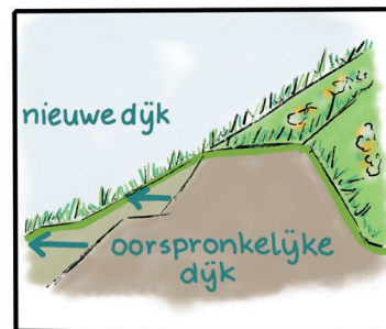
Flauwer buiten talud
