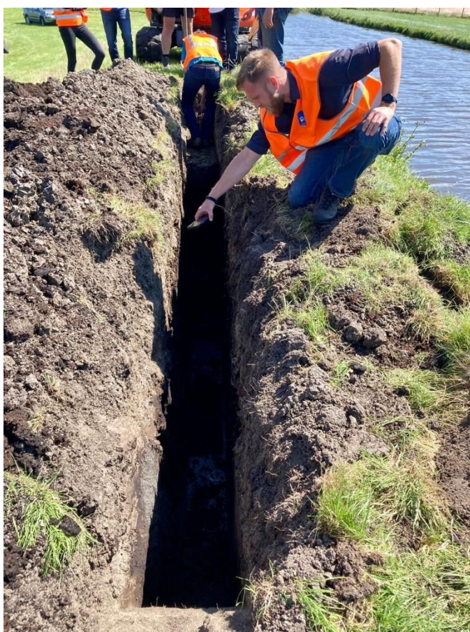
Foto: Waterveiligheidsadviseur maakt met LiDAR opnames van de kleikist, resultaat is een 3D opname die van alle kanten kan worden bekeken.
