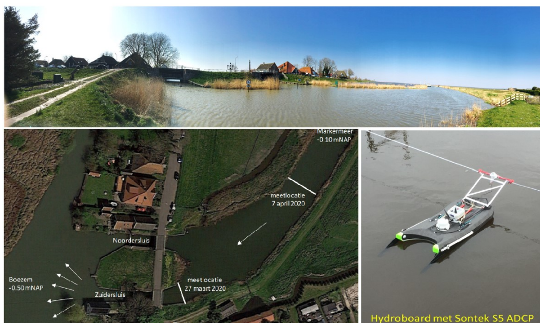
Figuur 4.3. Zuidersluis en Hydroboard met sonar apparatuur tijdens meting van het inlaatdebiet (foto: Olivier Hoes)
