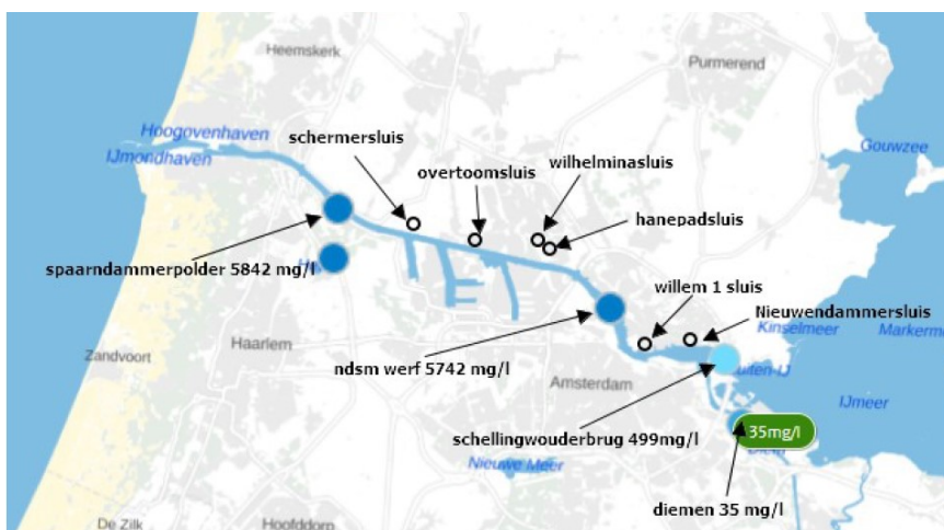
Afbeelding 4.11. Uitwisselpunten met Noordzeekanaal. De concentraties die worden weergegeven (zoals bij Diemen) betreffen metingen van Rijkswaterstaat.
