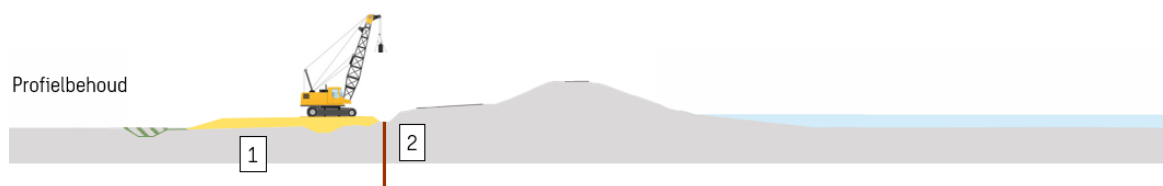
Figuur 2-4: Globale fasering Profielbehoud met damwand, nummering overeenkomstig de werkstappen. N.B.: dimensionering is niet op schaal
