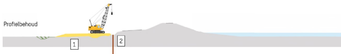
Figuur 6-13: Globale fasering Profielbehoud met damwand, nummering overeenkomstig de werkstappen. N.B.: dimensionering is niet op schaal
