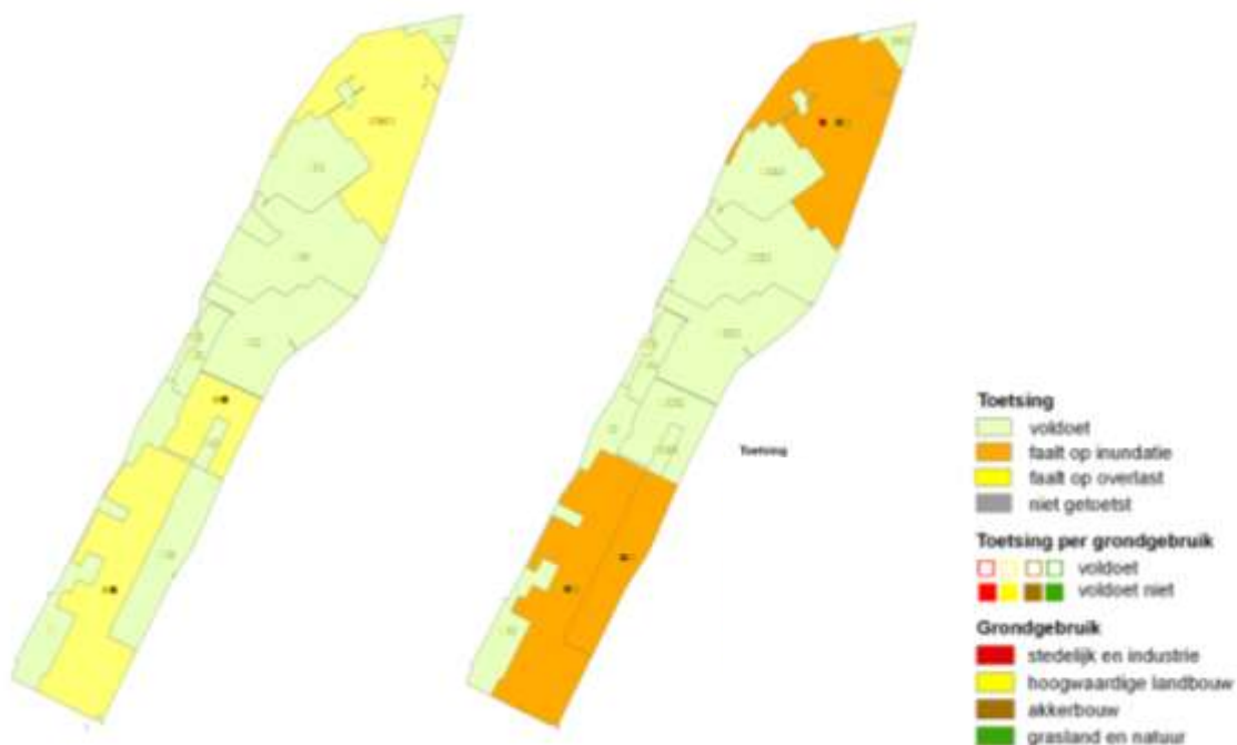
Figuur 2: Toetsing van het systeemgedrag (2050 middenscenario) aan de normen voor inundatie (NBW) en overlast (WBP2).
