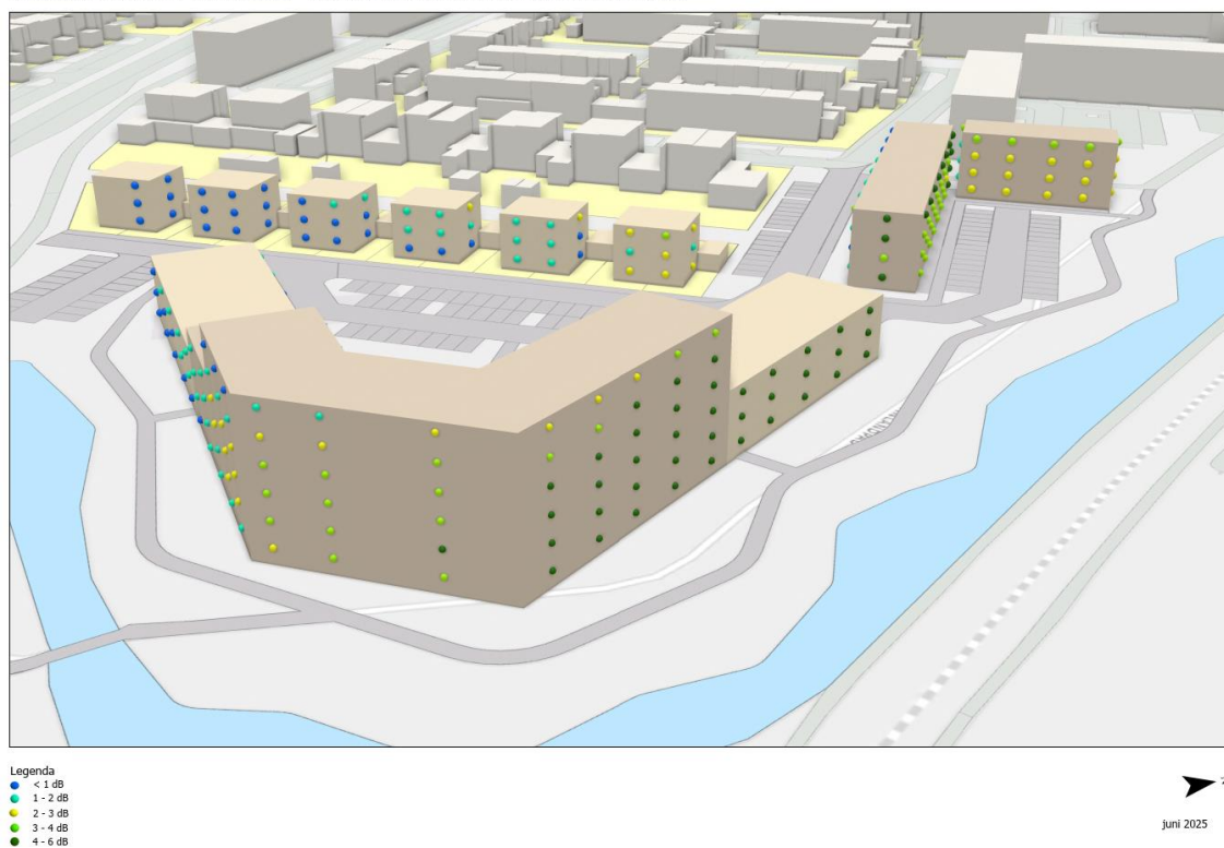
Afbeelding 9 : Geluidsreducerende effect hoogstbelaste oostzijde door ophoging geluidswal N210
