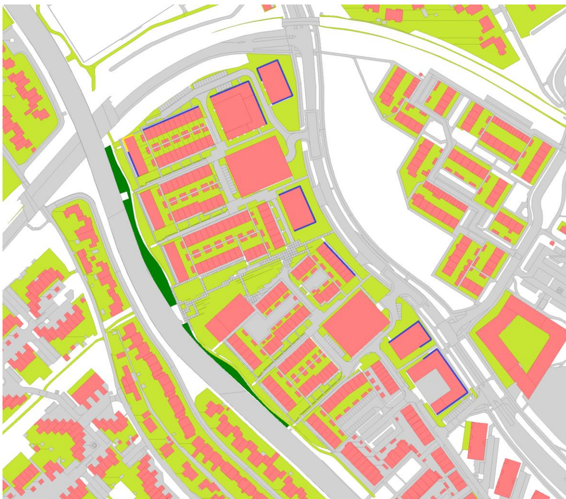
Afbeelding 4.1: gevels met overschrijding standaardwaarde (blauw alleen wegverkeer, geel voor weg- en railverkeer).
