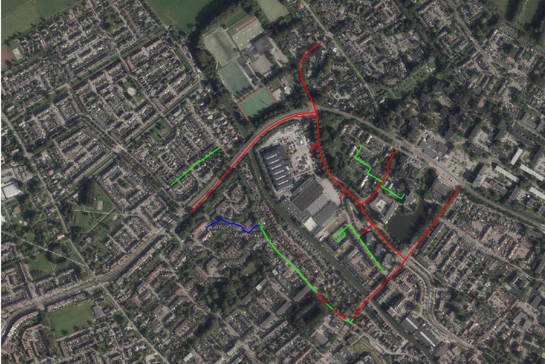
Afbeelding 3.2: rood geeft standaardasfalt aan, groen klinkers in keperverband en blauw klinkers niet in keperverband.
