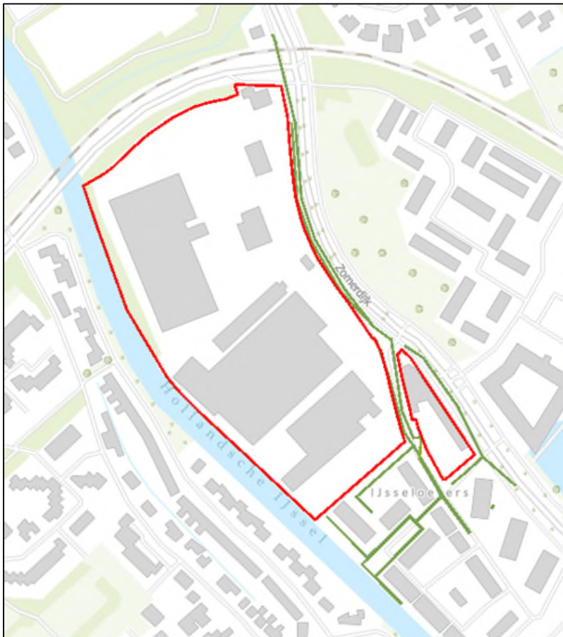
Figuur 9: Ligging riolering (in groen) onder vrij verval.
