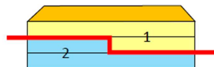
Gecombineerde splitsing van het gebouw
