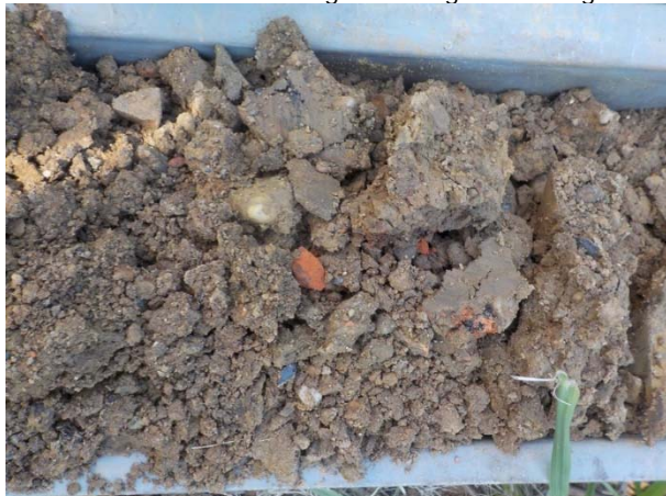
Foto 07. Bodemvreemde laag in ondergrond boring 01
