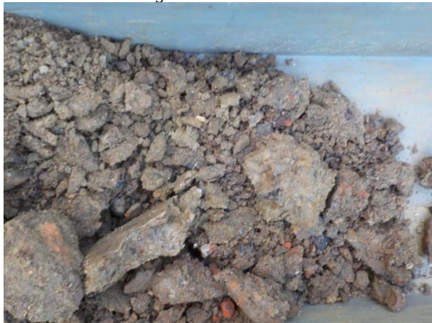
Foto 5. Bodemvreemde laag in ondergrond boring 02
