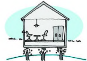
Grondwaterpeil te laag: paalrot
