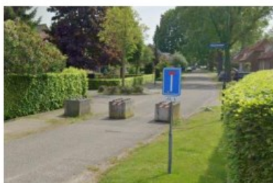
Figuur 15: Fysiek statische knip met betonblokken
