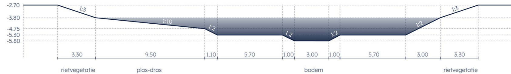
doorsnede A - A' (1:200): bodemdiepte van 2.00 m met slibgeul (voorkeursvariant HB)
