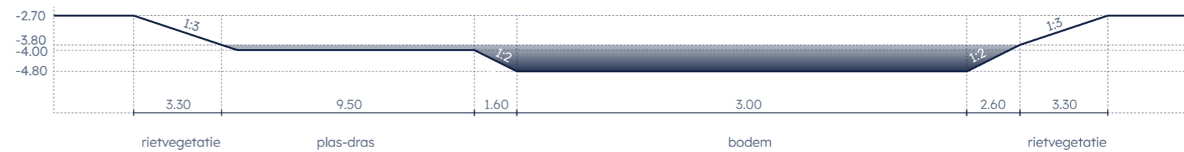
doorsnede A - A' (1:200): bodemdiepte van 1.00 m zonder slibgeul
