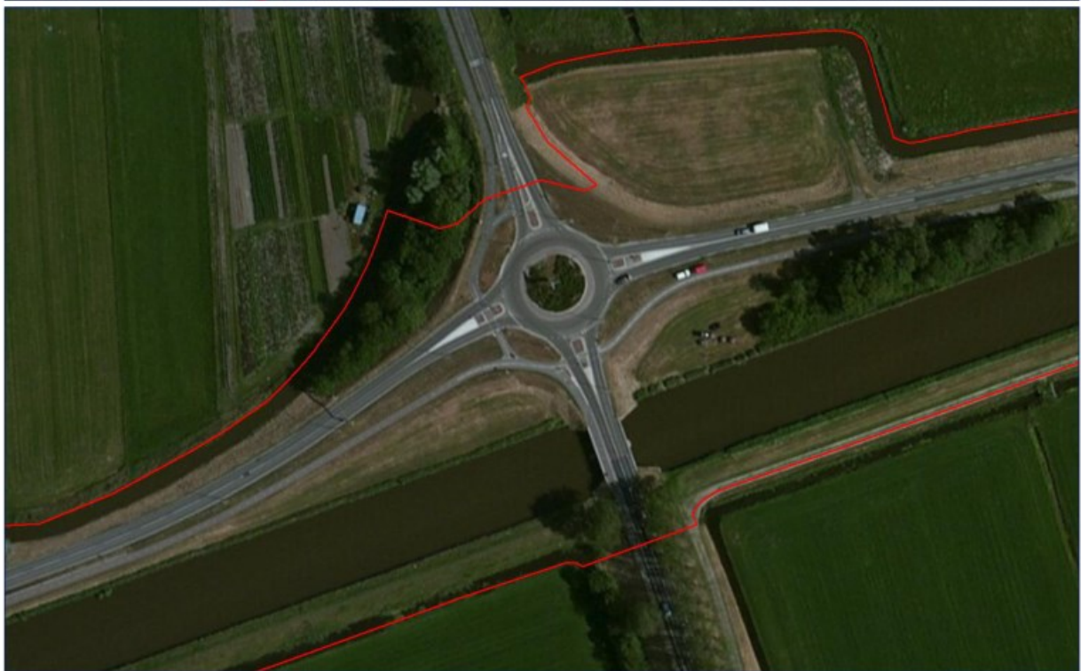
Figuur 17: Opnamen van de Lasschoterbrug en de huidige rotondein de N241 – N248. Naar aanleiding van deze beelden is vast te stellen dat de brug naoorlogs is verbreed.
