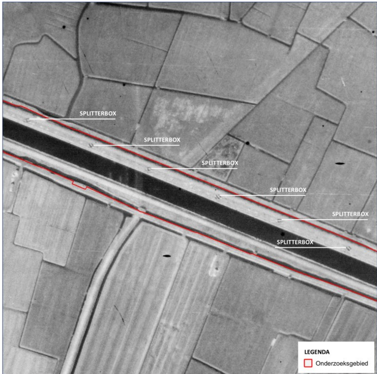
Figuur 13: Detail van de luchtopname van 26 februari 1945 ter plaatse van het kanaal Alkmaar-Kolhoorn tussen de Burenbrug en de Mielbrug. Langs het kanaal zijn aan de weg op een regelmatige afstand van circa 90 meter splitterboxen aangelegd.
