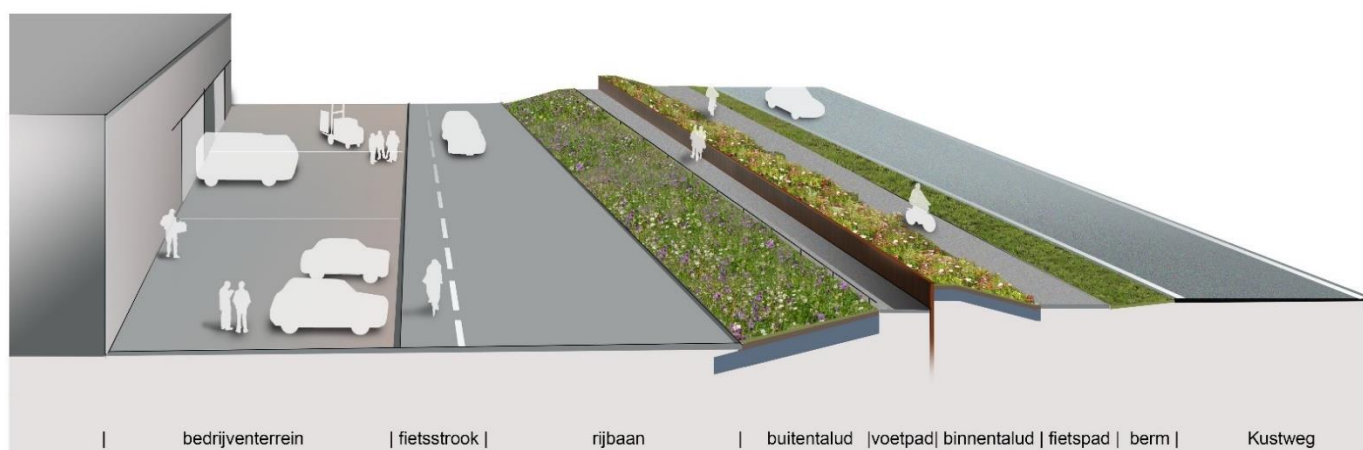
Figuur 5-6 Visualisatie Havendijk - Sectie 7 – kruinverhoging met een verticale keerconstructie (damwand) en talud 1:4.
