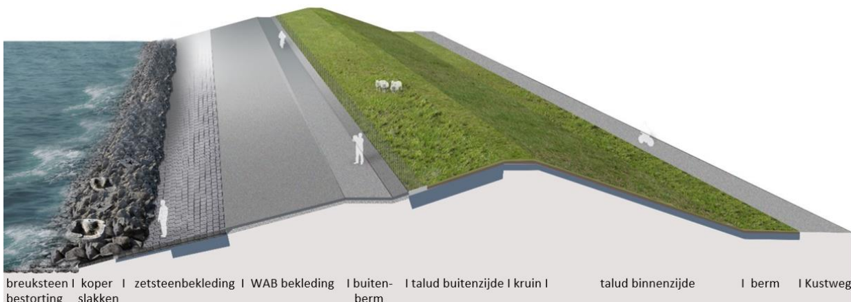
Figuur 3-1 Impressie van de landelijke dijk. Het bovenste deel van het talud aan de buitenzijde van de dijk wordt voorzien van gladde bekleding, de onderzijde wordt ruw (stortsteen). De kruin en binnenzijde worden ingezaaid met een (eventueel bloem-/kruidenrijk) grasmengsel.
