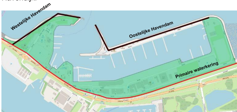
Figuur 2 Haven Lauwersoog. De rode lijn geeft de primaire waterkering weer en de zwarte lijnen de havendammen. De groene vlakken zijn de hooggelegen voorlanden (bron: Veiligheidsoordeel Lauwersmeerdijk-Vierhuizergat, 2018).
