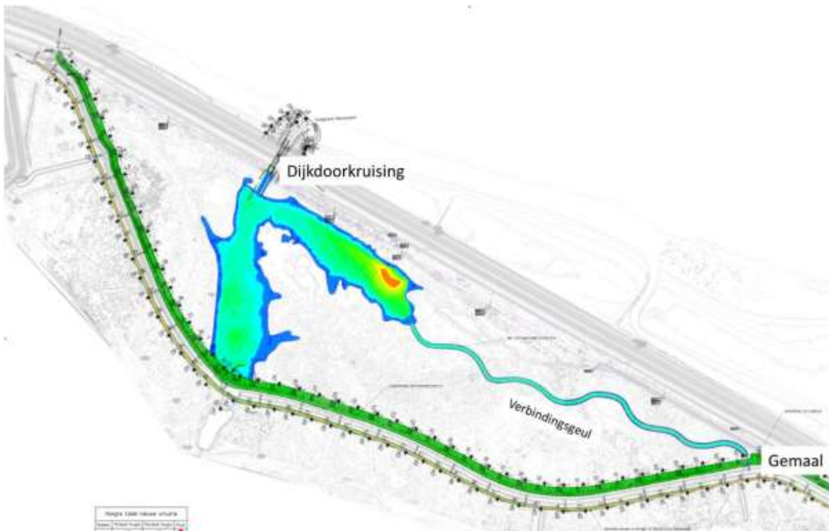
Figuur 1-1: Overzicht braakwatergebied met dijkdoorkruising en gemaal
