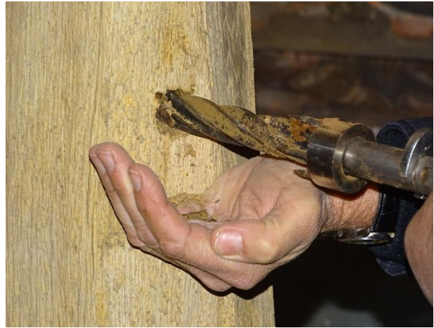
Afb. 3.10 Het opvangen van mogelijke losse delen van het boormonster
