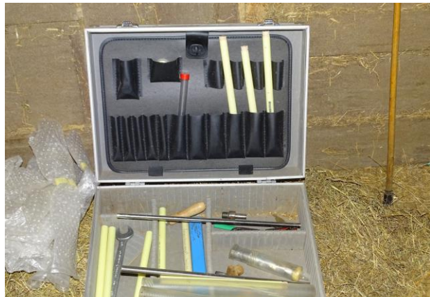
Afb. 3.2 Koffertje met materialen voor dendrochronologisch onderzoek
