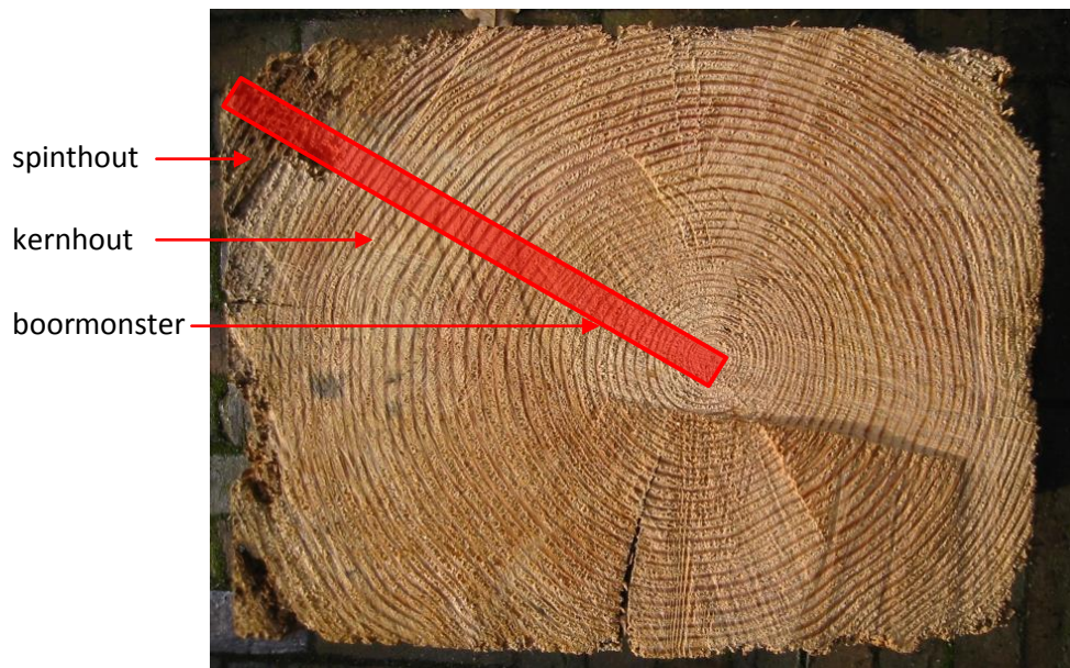
Afb. 2.5 Doorsnede hout met een juist uitgevoerde boring van bast tot kern, in rood aangegeven (8)
