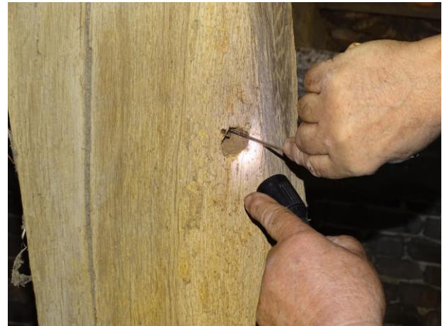
Afb. 3.12 Het lossnijden van het boormonster met een haakje
