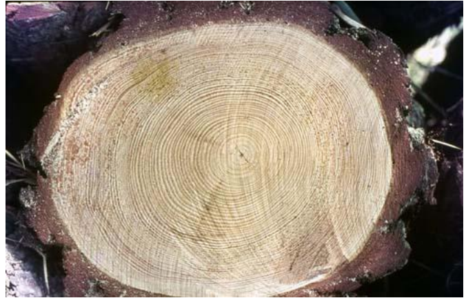
Afb. 2.3 Doorsnede essenhouten stam met duidelijk herkenbaar kernhout en bast (8)
