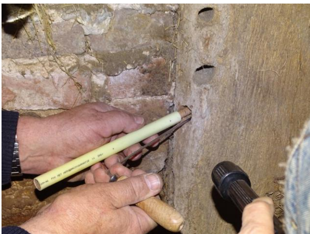
Afb. 3.13 Het verwijderen van het boormonster en opbergen in een pvc-kokerboren van gebintstijl
