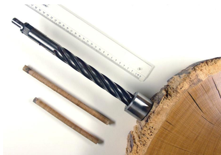
Afb. 2.6 Voor dendrochronologisch onderzoek geschikte boor en twee boormonsters (1)
