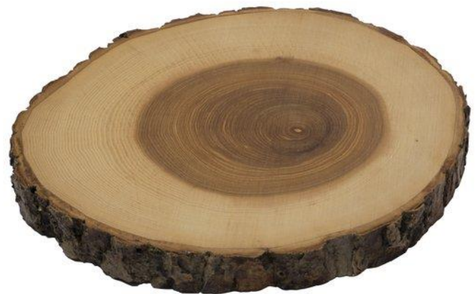
Afb. 2.4 Doorsnede grenenhouten stam met spinhout en bast (8)
