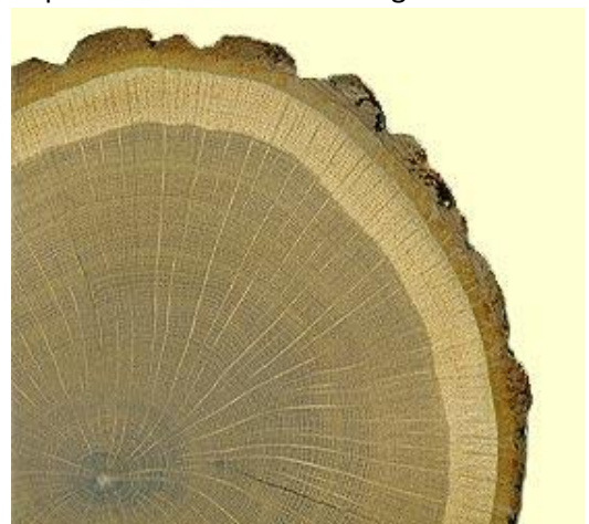
Afb. 2.2 Doorsnede eikenhouten stam met duidelijk herkenbare lagen kernhout, spinhout en bast (8)
