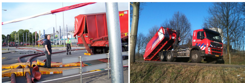
Figuur 2. Grootwatertransportsysteem en waterwagen.
