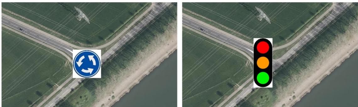
Afbeelding 34 Schematische weergave kruispuntoplossingen Roermondseweg-Rijksweg
