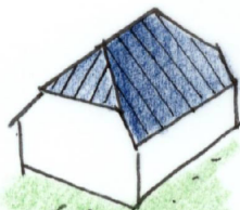
dak met wolfseinden
