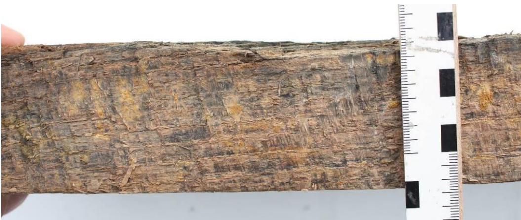
Fig. 8.23. Mierlo-Luchen. Zaagsporen op zijkant van eikenhouten plank (V254).
