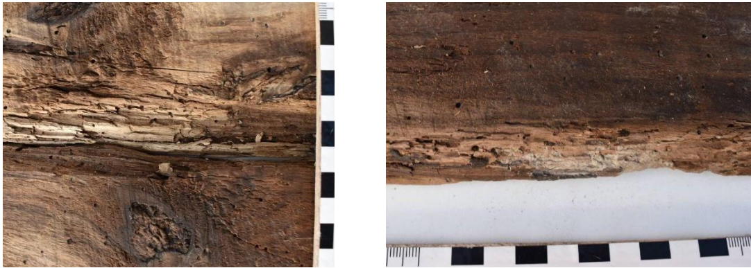
Fig. 8.16. Mierlo-Luchen. Houtwormgaten op de brede kant en op de zijkant met spintresten van eikenhouten plank (V258/V263).
