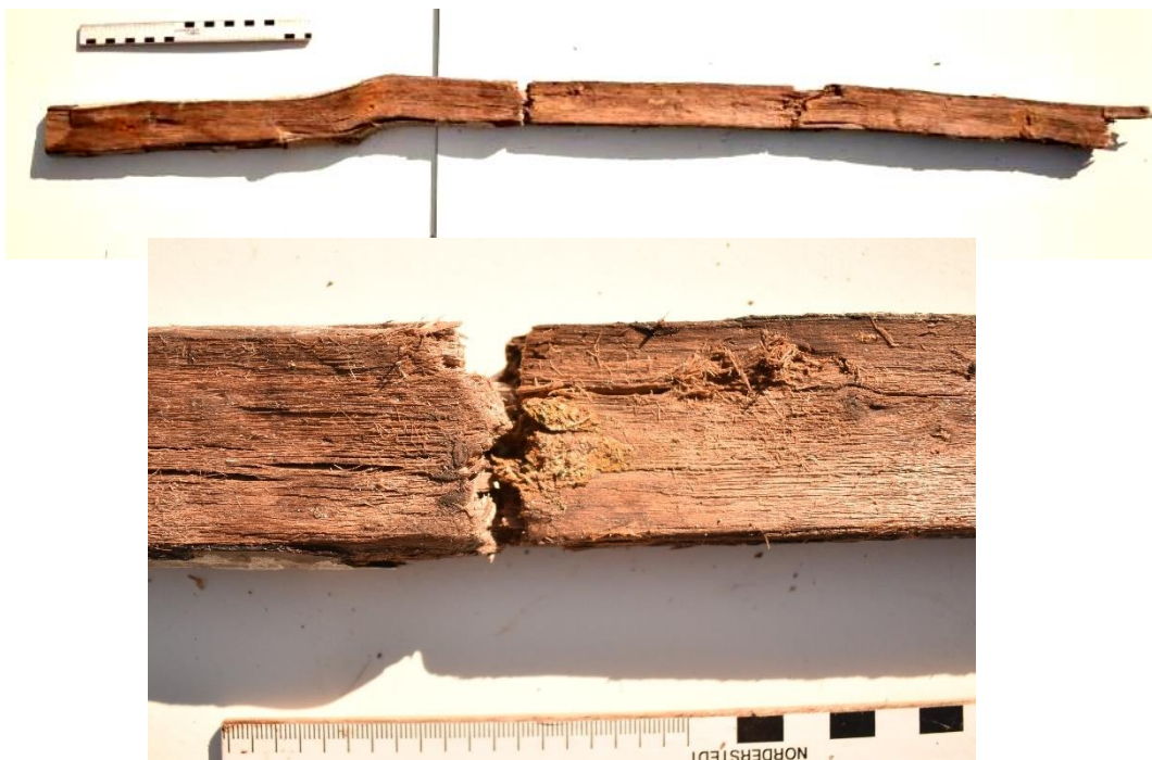
Fig. 8.40. Mierlo-Luchen. Elzenhouten lat met natuurlijke kromming (V218.2). Onder: detail van spijkergat met corrosieresten, waarop de lat is gebroken.
