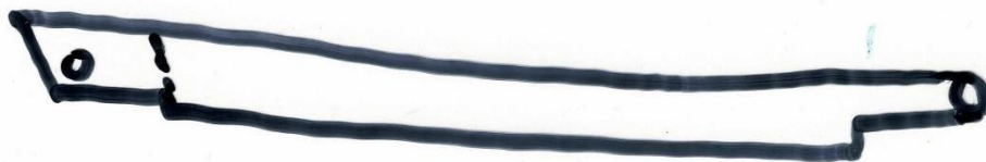
Fig. 8.31. Mierlo-Luchen. Schets van een spaak. Het uiteinde voor in de naaf is plat en trapeziumvormig uiteinde en heeft een gat voor in de naaf. Het andere uiteinde voor in het spaakgat van de velg staat niet centraal en is rond afgewerkt.
