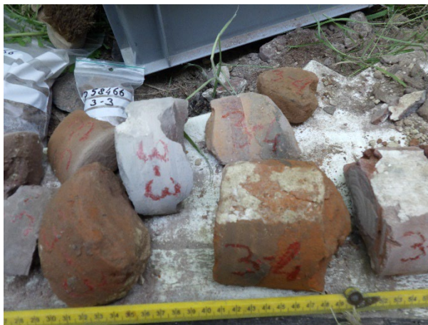
Figuur 3.23: 3-3, kern verbrokkeld. Breukvlakken op stenen en voegen
