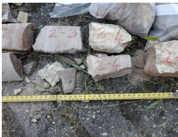
Figuur 3.14: 2-3 en 2-4 kern verbrokkeld
