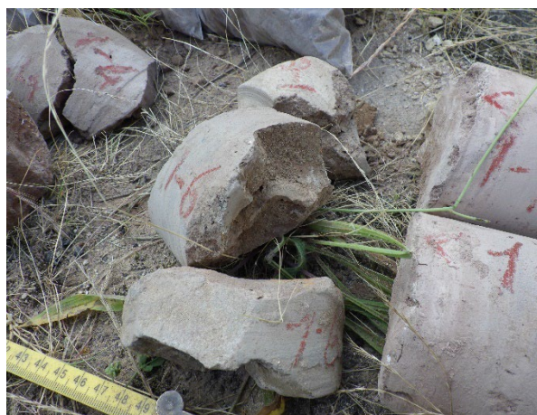
Figuur 3.6: Deel 1-6 verbrokkeld. Breukvlakken door de stenen
