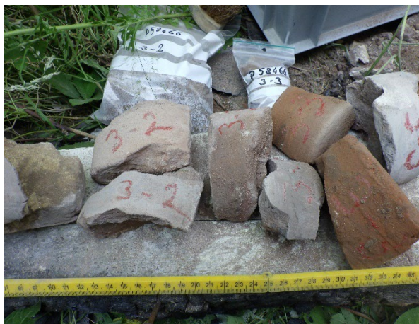
Figuur 3.22: 3-2 en 3-3, verbrokkeld en vergruisd
