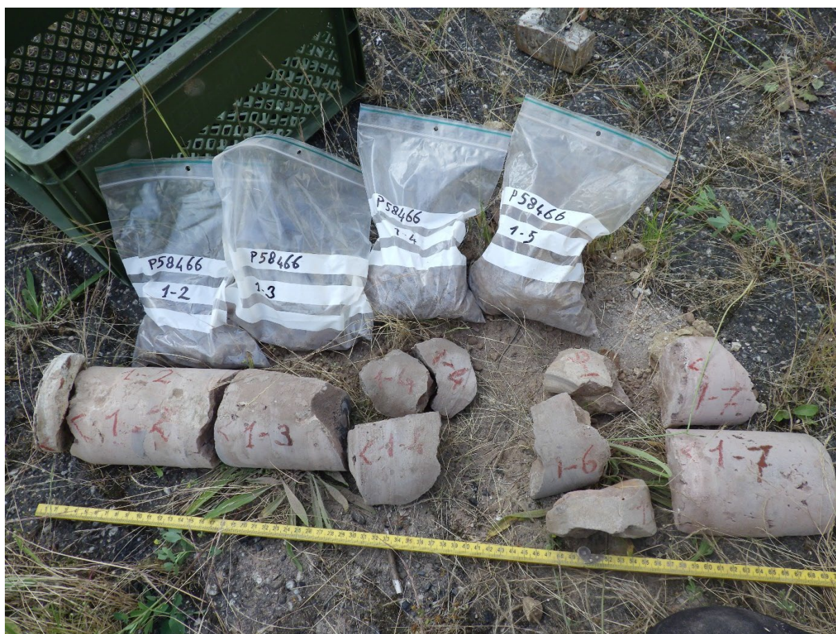
Figuur 3.1: Kern 1 met links de buitenzijde van de muur
