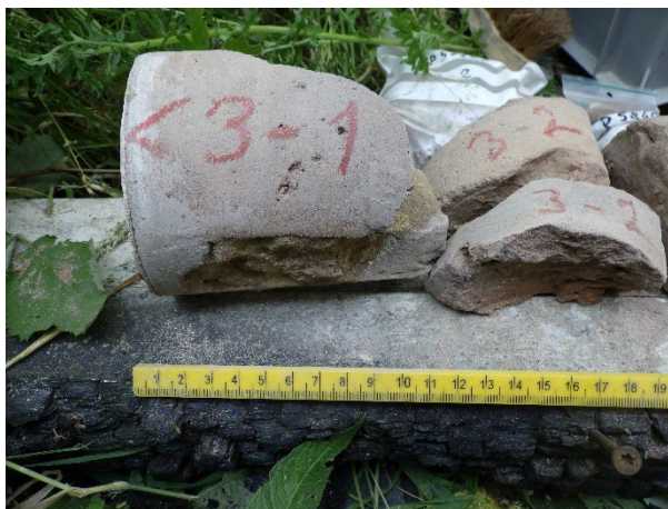
Figuur 3.21: 3-1, buitenzijde. Pleisterwerk hecht nog goed
