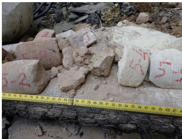
Figuur 3.34: Deel 5-3 vergruisd. Geen samenhang
