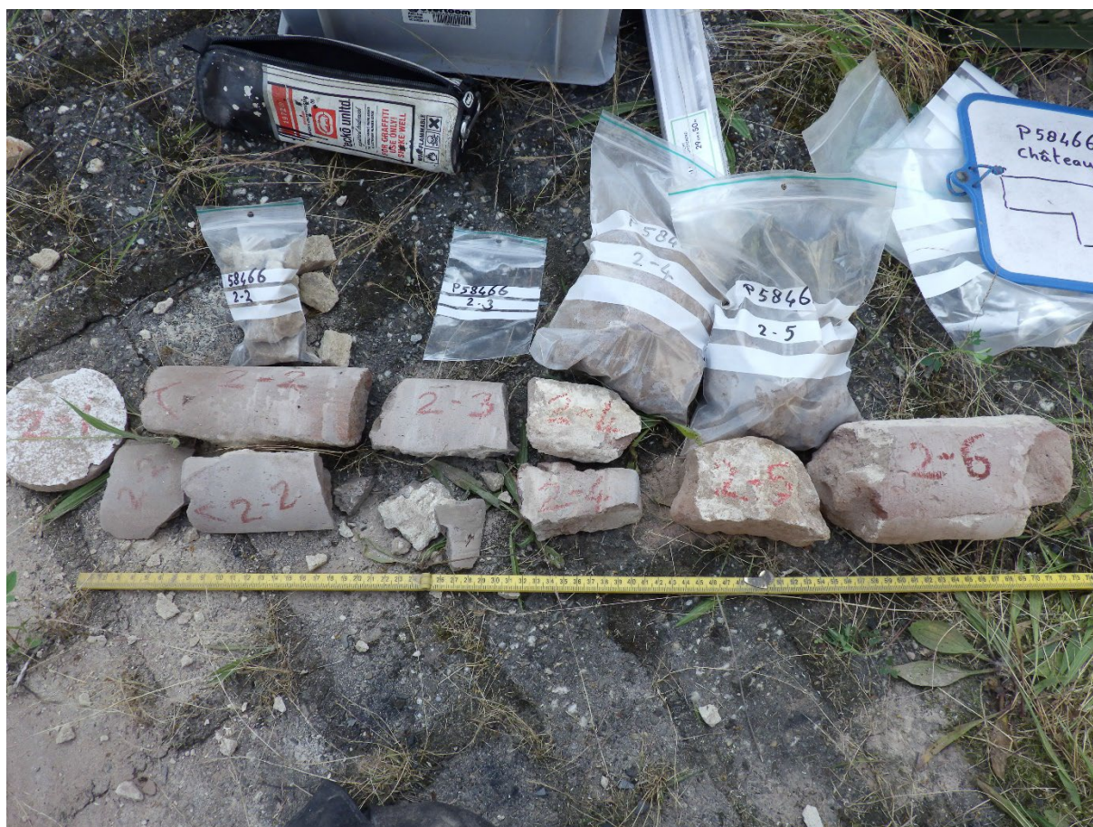
Figuur 3.11: Kern 2 met links de buitenzijde van de muur
