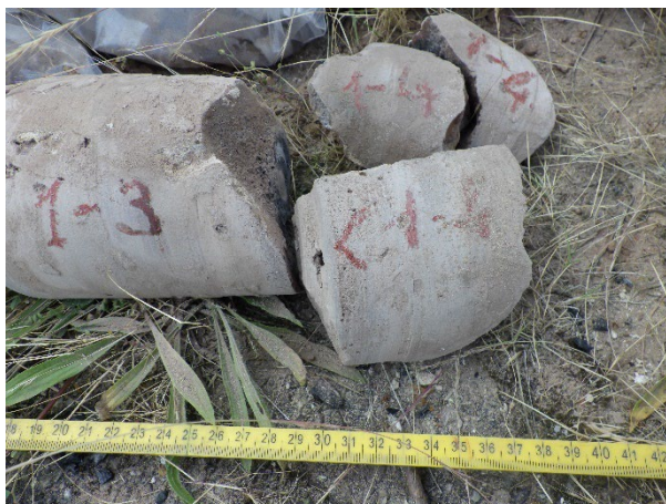
Figuur 3.3: Kern verbrokkeld in stukken van 12 cm tot volledig gruis
