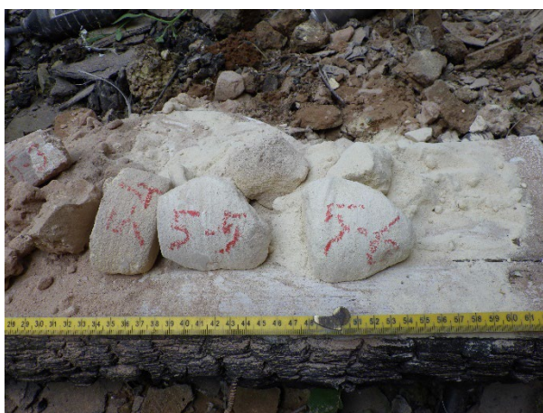
Figuur 3.35: 5-5 en 5-6, gelige, zachte steen. Mogelijk kalksteen (niet nader onderzocht)
