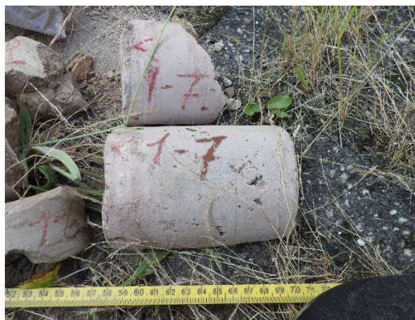
Figuur 3.8: 1-7, binnenzijde. Verbrokkeld maar geen verkleuring of delaminatie door de hitte
