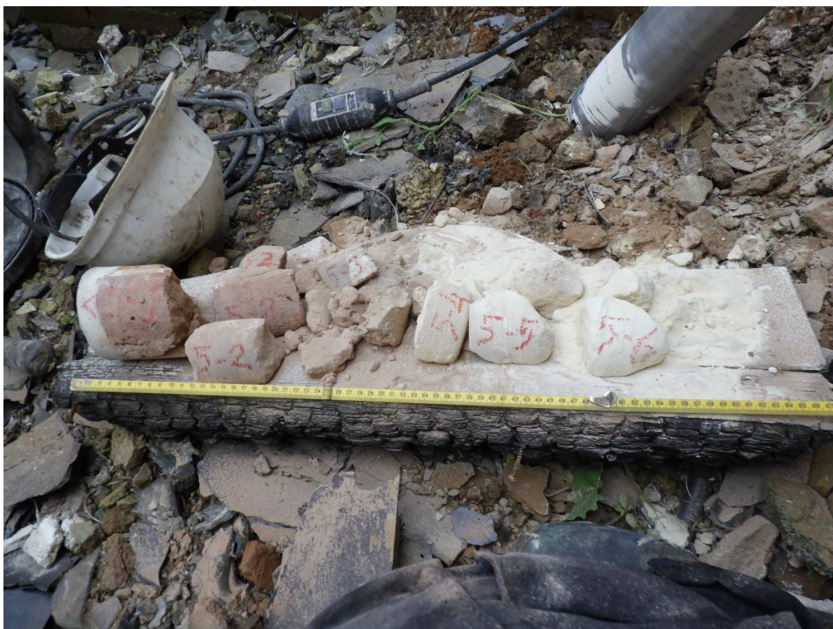
Figuur 3.31: Boorkern 5 met links de binnenzijde
