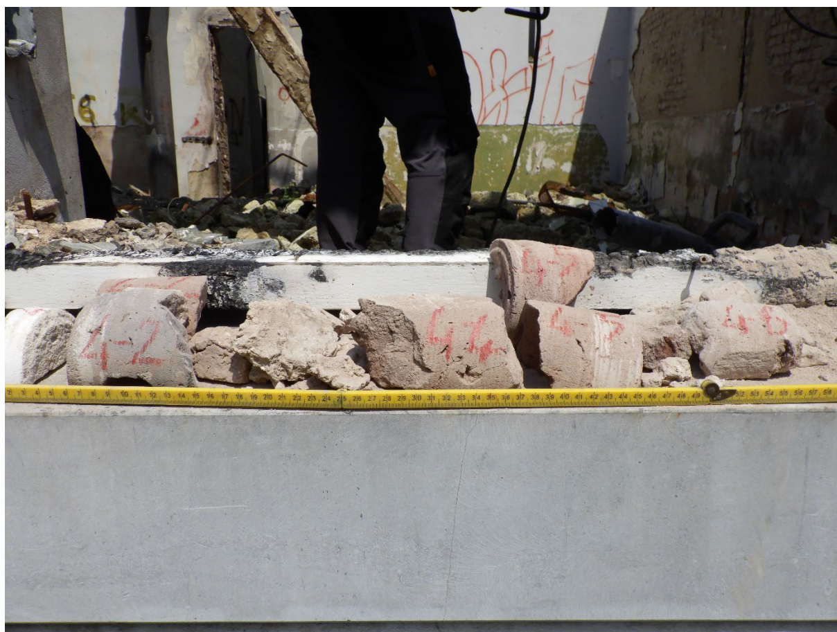
Figuur 3.25: Boorkern 4-1 met links de binnenzijde
