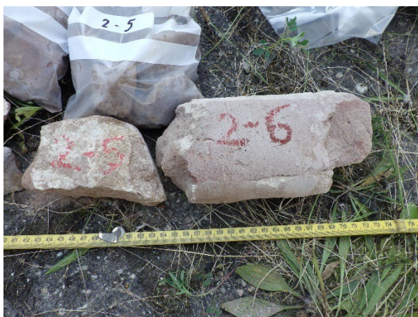
Figuur 3.15: 2-6, binnenzijde. Verbrokkeld maar geen verkleuring of schade door hitte te zien
