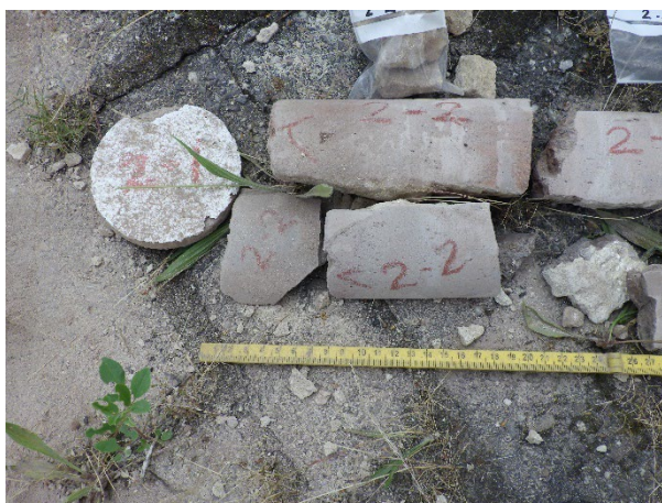
Figuur 3.13: 2-1 en 2-2. Pleister laat los en kern gespleten
