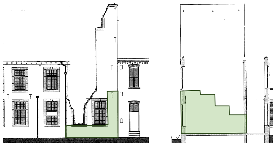
Te handhaven metselwerk (groen) van zuid- en oostgevel toren.
