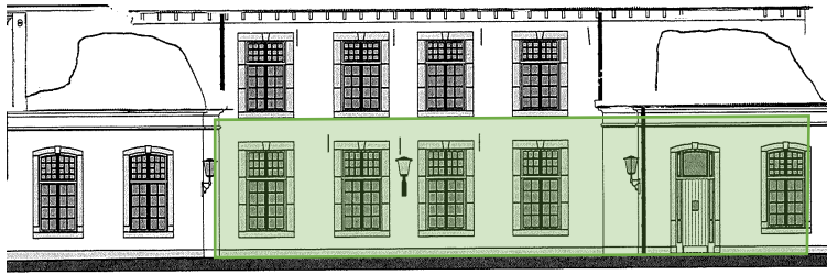
Te handhaven metselwerk noordelijke gevel vleugel 17 e -eeuw.
