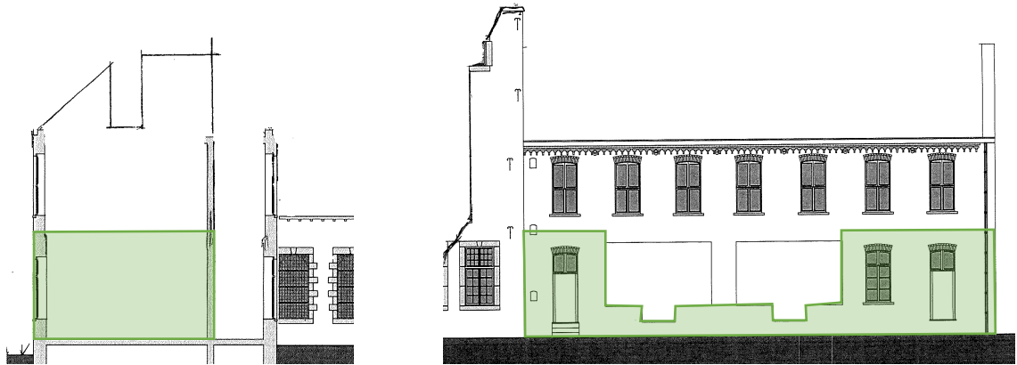
Te handhaven metselwerk meest westelijk gelegen binnenwand en zuidelijke gevel.
