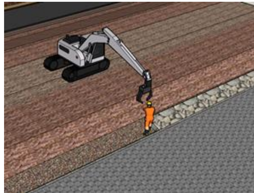
Aanbrengen basaltstenenbekleding en ringslangverblijven Aanbrengen basaltstenenbekleding en sierstrook
