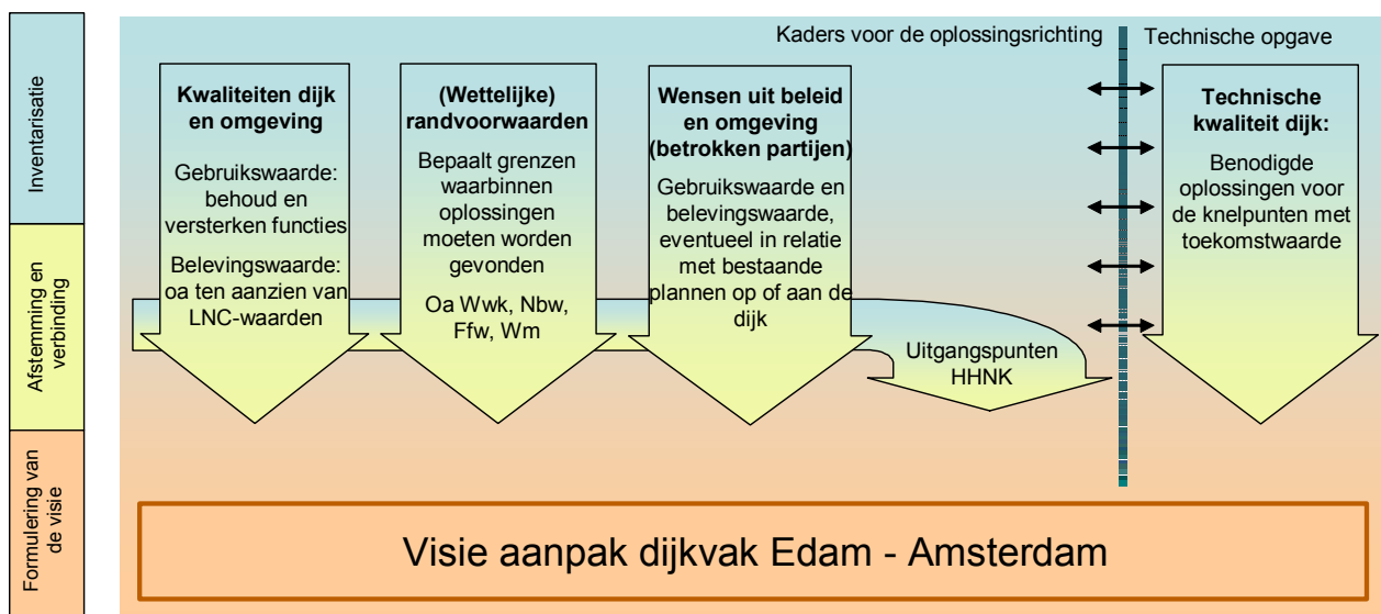
Figuur 4.1 Totstandkoming van de visie op de versterking van de dijk tussen Edam en Amsterdam
